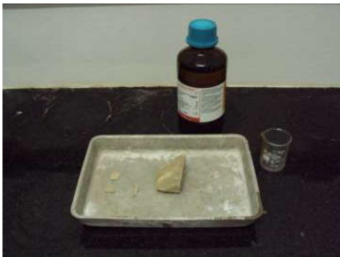
Figura 2.7 - Materiais utilizados para a realização do teste: bandeja, copo de Becker e ácido clorídrico (HCl) a 10%. Fonte: autor.
