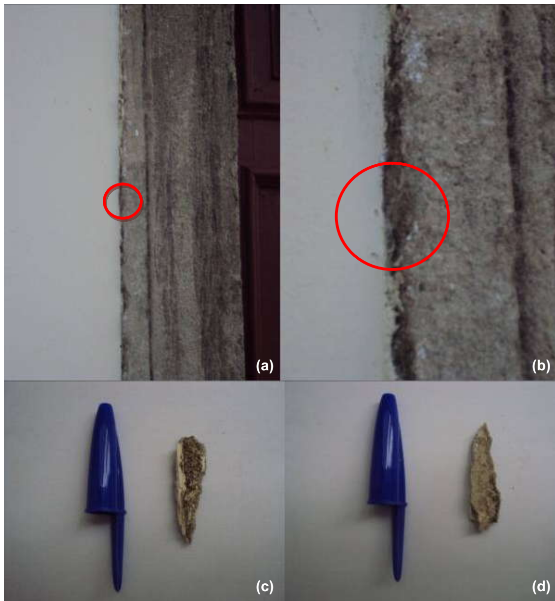
Figura 3.2 - Amostra 02 coletada no frontispício da INSP. (a) e (b) local da coleta – portada lateral direita, ombreira direita; (c) e (d) amostra 02 - (c) superfície exposta; (d) superfície interna. Fonte: autor.
