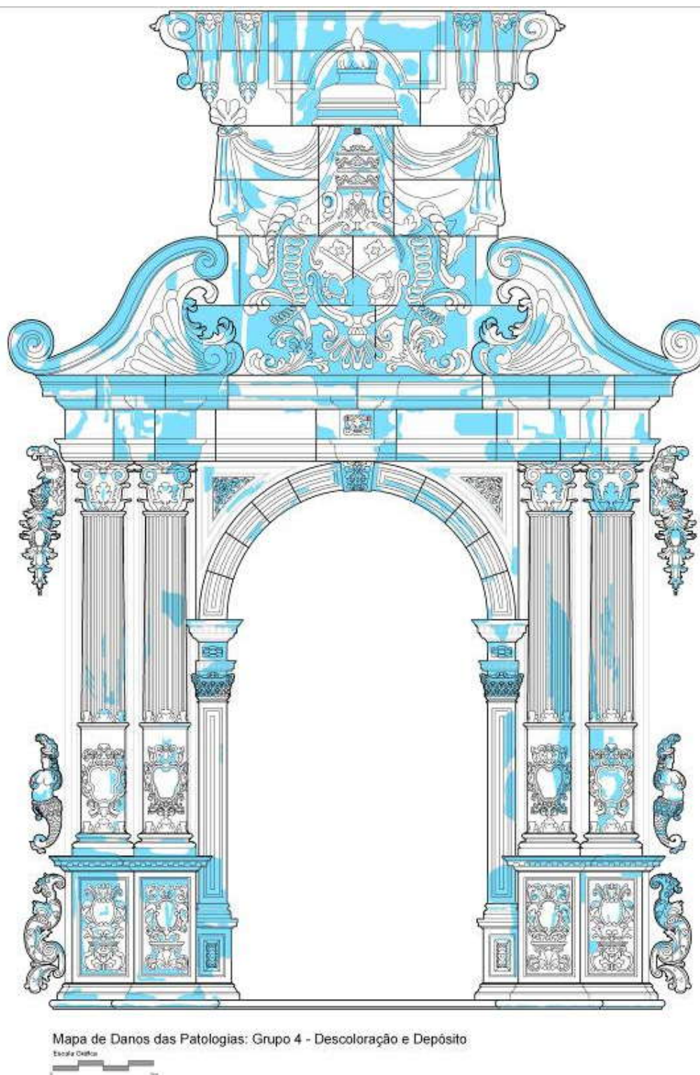
Figura 3.44 - Mapa de danos do pórtico central da Igreja de São Pedro dos Clérigos com a distribuição das patologias do Grupo IV – Descoloração e Depósito sobre a superfície dos blocos que compõem o bem integrado, identificado como ISPC_F1NE_1PC_100B. Fonte: autor.
