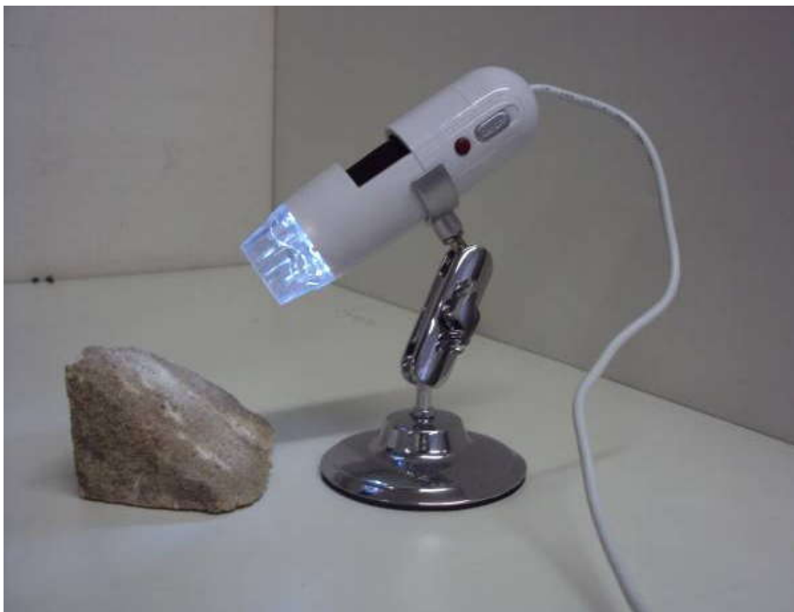
Figura 2.2 – Lupa utilizada para captação das imagens e fotografias relativas ao material pétreo coletado (amostras). Fonte: autor.
