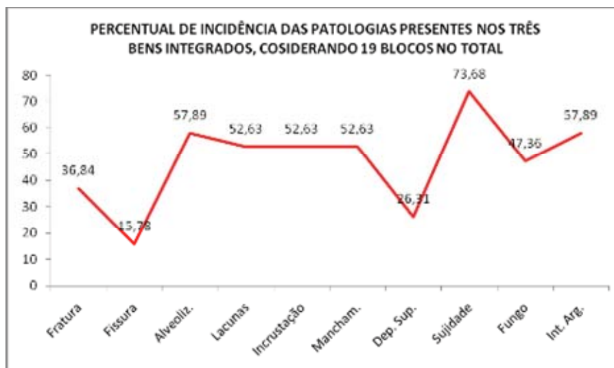
Figura 3.59 - Gráfico com o percentual de incidência das patologias presentes nos três bens integrados da INSP.
