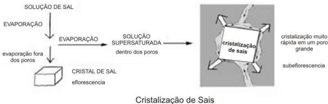
Figura 1.8 - Processo de cristalização de sais no interior de um poro; compilado e modificado de Torraca (2009).
