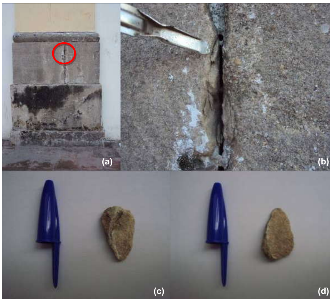
Figura 3.1 - Amostra 01 coletada no frontispício da INSP. (a) e (b) local da coleta - pilastra, base; (c) e (d) amostra 01 - (c) superfície exposta; (d) superfície interna. Fonte: autor.
