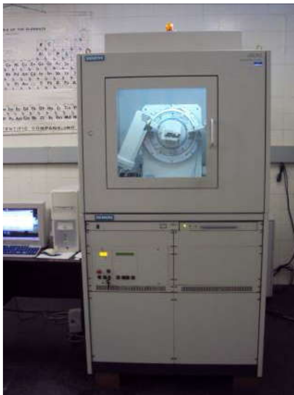
Figura 2.9 - Equipamento utilizado para a difração de RX; difratômetro marca Siemens, modelo D5000. Fonte: autor.
