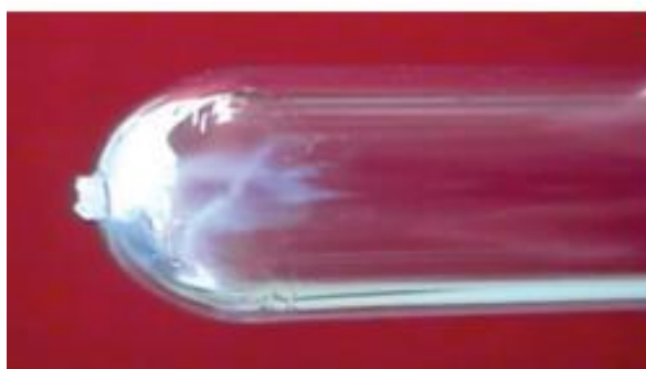
Figura 11 - Exemplo de opacidade em pré-forma na região do bico de injeção.
