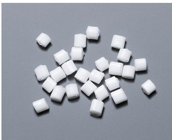
Figura 6 - Resina PET na fase semicristalina.
