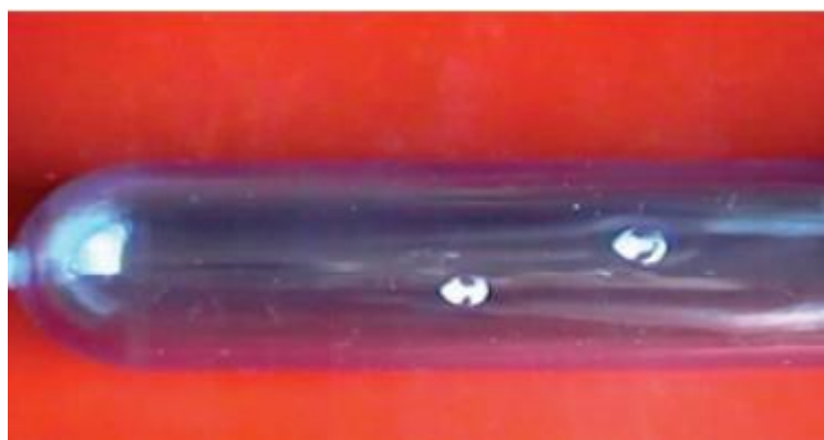
Figura 12 - Exemplo de difusibilidade superficial em pré-forma.
