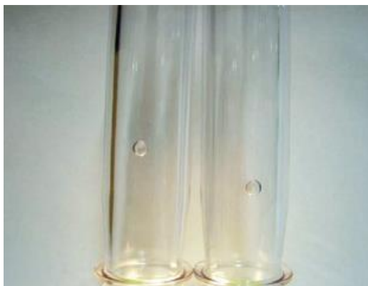
Figura 9 - Incidência de bolhas em pré-forma.
