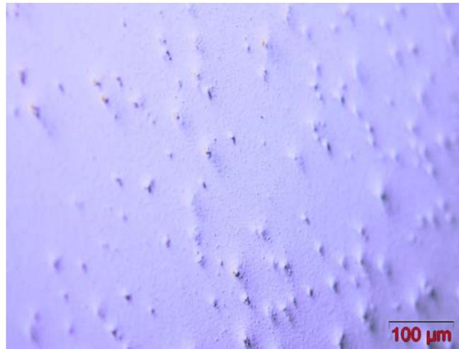
Figura 5.13. Fotografia em microscopia ótica a temperatura do fio BSW submetido ao tratamento térmico BSW-T1.
