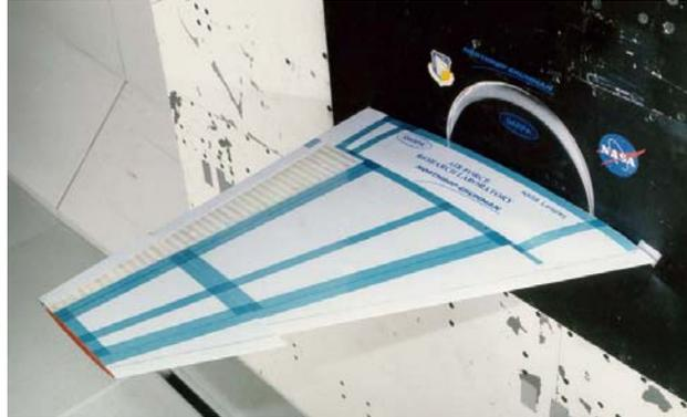
Figura 3.20. Vista do protótipo de uma asa do F-18, funcionamento relacionado ao torque gerado por fios e tubos de Ti-Ni (Dimitris, 2008).
