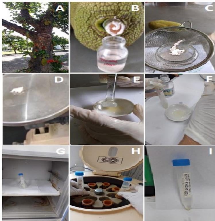
**A)** Árvore da espécie *Artocarpus heterophyllus* Lam, **B)** Extração do látex a partir do pedúnculo do fruto, **C)** Obtenção da massa viscosa e **D)** Pesagem da massa, **E)** Maceração da massa com óleo mineral, **F)** Obtenção de líquido viscoso, **G)** Aquecimento do líquido viscoso em estufa, **H)** Centrifugação do líquido viscoso, **I)** Líquido viscoso filtrado. **Fonte:** Paz (2022).
