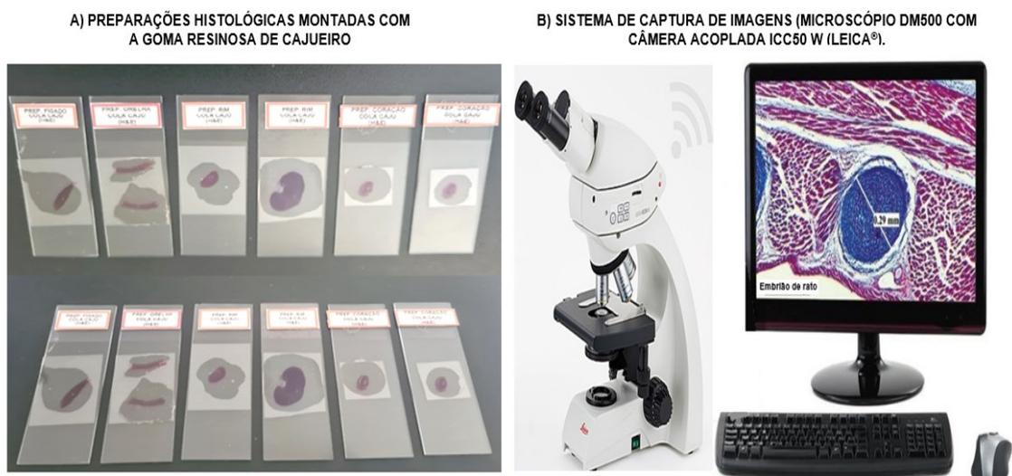
**A)** Fotos de preparações histológicas montadas com meio natural processado a partir da goma resinosa de cajueiro. **B)** Visualização do sistema de captura de imagens (microscópio DM500 com câmera acoplada ICC50 W, Leica). **Fonte:** Paz (2022)
