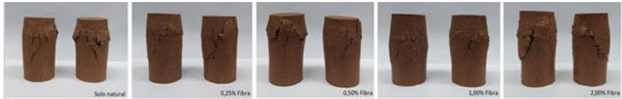
Figura 22 – Fotografias do formato das rupturas dos corpos de prova com adição de diferentes percentuais de fibras de polipropileno.
