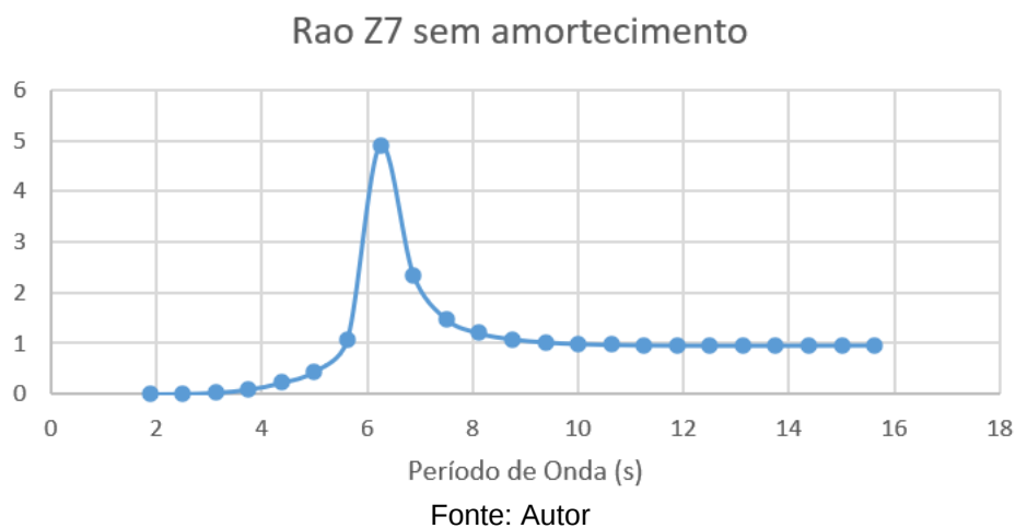
Figura 42 – Resposta para elevação da coluna d'água sem amortecimento para um CAO no Porto do Recife
