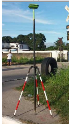
Figura 9 - Modelo de Marco Geodésico implantado em Jaboatão dos Guararapes
