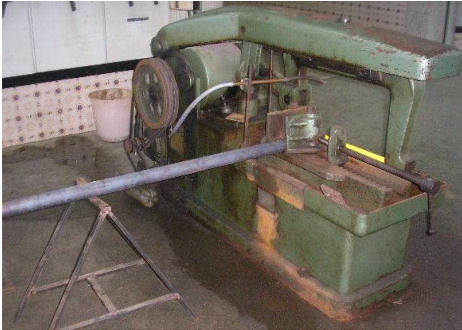
Figura 4.6 – Barra cilíndrica sendo cortada na serra alternativa do IFPE
