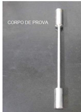
Figura 4.12 – Corpo de prova utilizado no ensaio de tração
