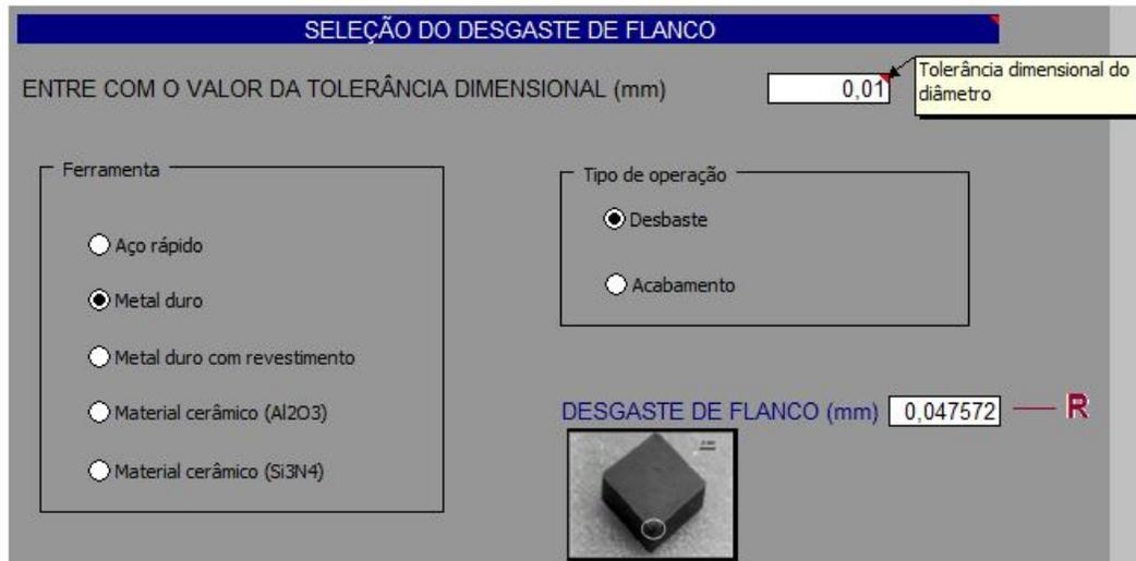
Figura 23 – Tela do SGF para determinação do valor do desgaste de flanco a ser considerado na operação de usinagem
