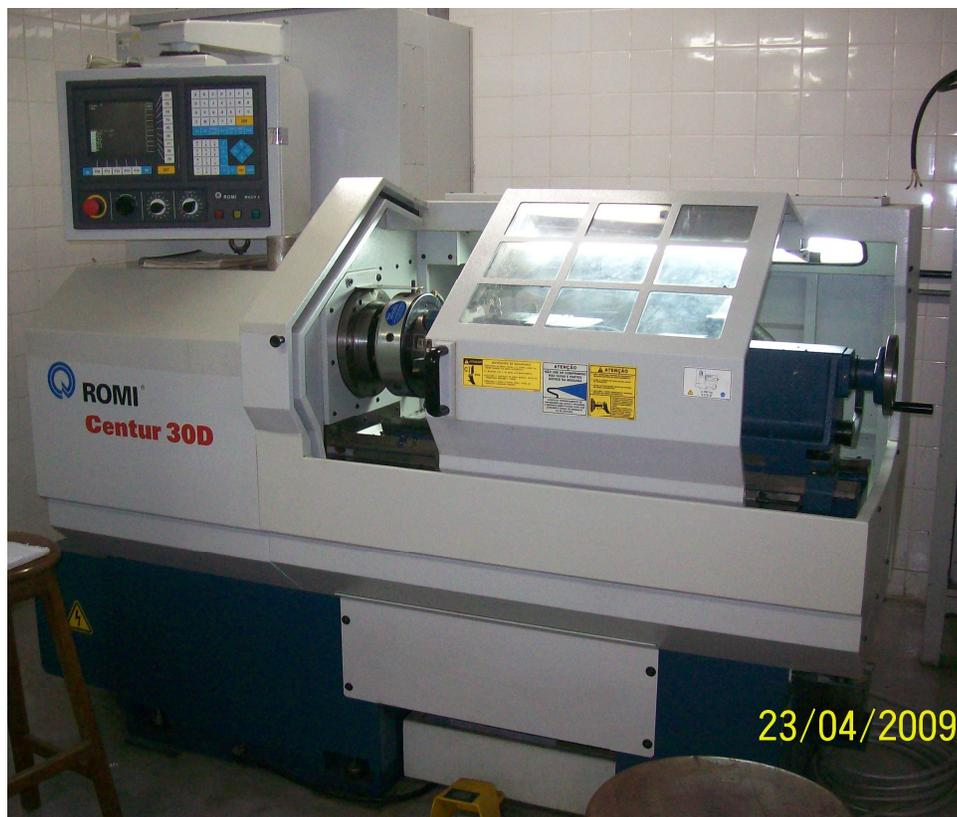
Figura 4.17 – Torno CNC utilizado para a fabricação de três peças dos experimentos
