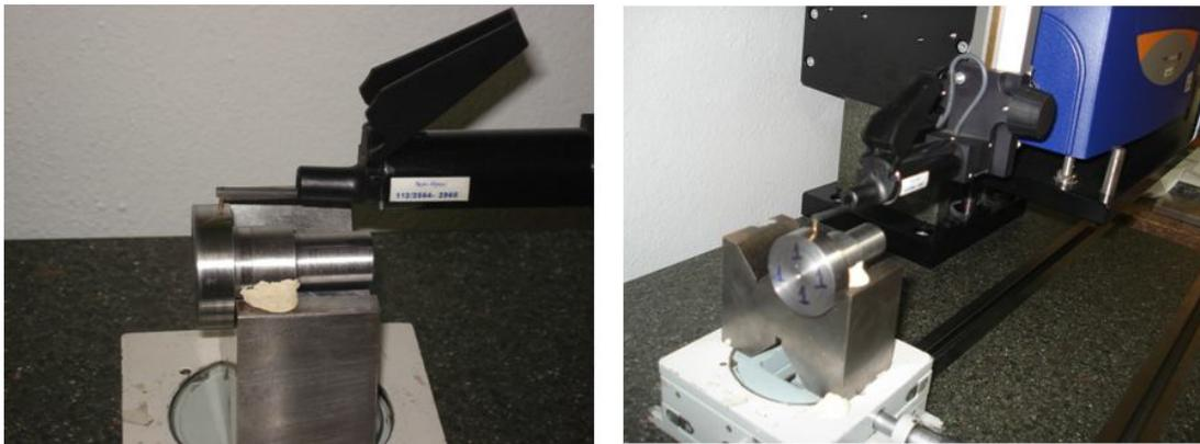
Figura 4.29 – Ilustração de duas diferentes posições na realização da medição de rugosidade
