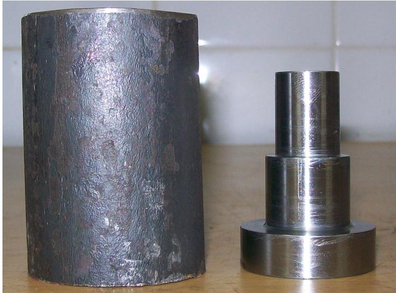
Figura 4.27 – Apresentação da peça bruta juntamente com a peça acabada produzida no torno Nardini
