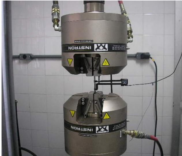
Figura 4.14 – Foto destacando a fixação do extensômetro no corpo de prova a ser ensaiado
