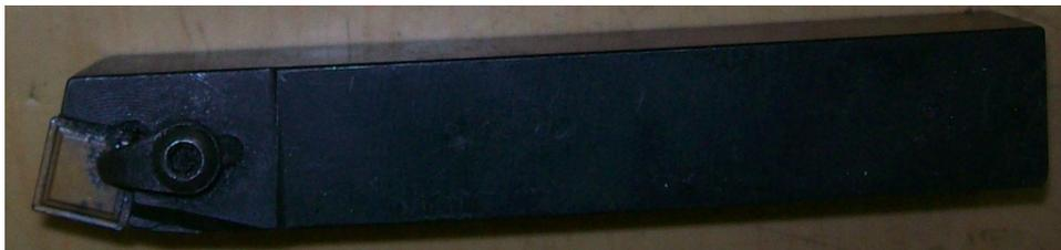
Figura 4.24 – Ferramenta de corte e porta-ferramenta utilizados no torno Nardini
