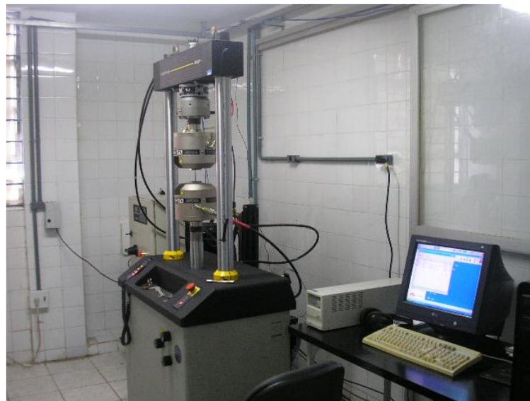
Figura 4.13 – Visão geral da máquina de ensaio de tração do Departamento de Engenharia Mecânica da UFPE
