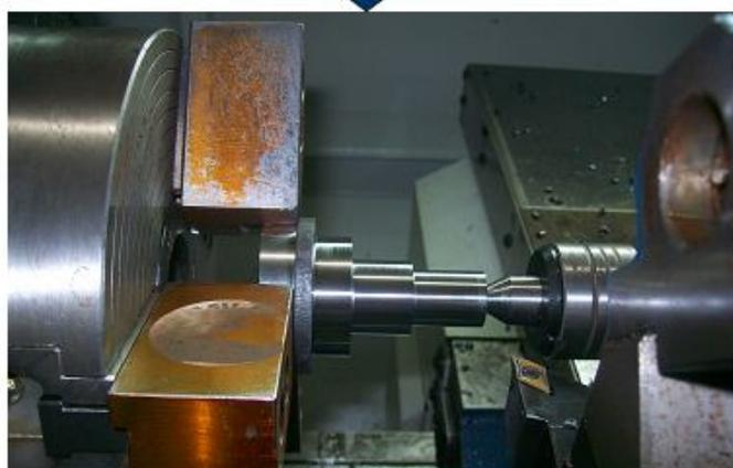
Figura 4.21 – Sequência de fabricação no torno CNC
