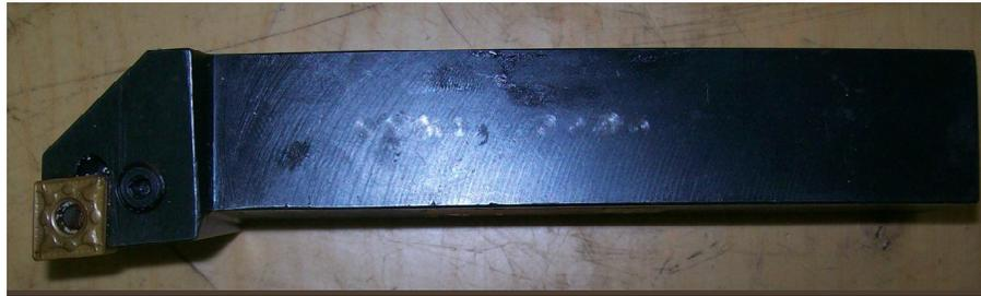
Figura 4.18 – Ferramenta de corte e porta-ferramenta utilizados no torno CNC
