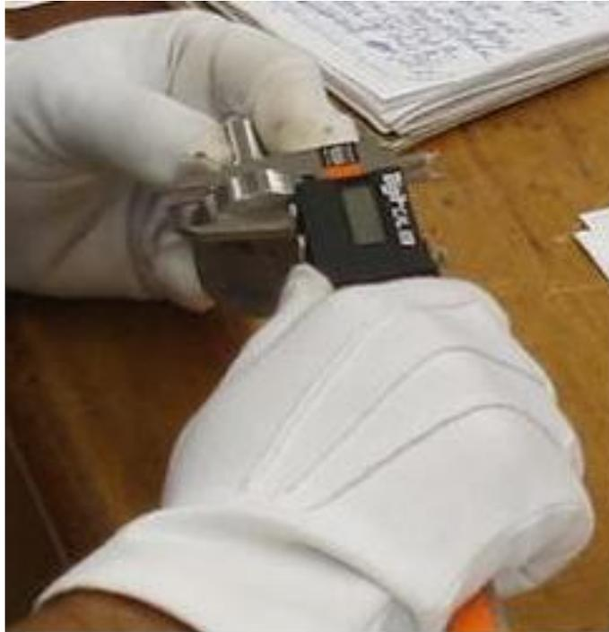
Figura 4.36 – Apresentação de uma medição de comprimento com paquímetro
