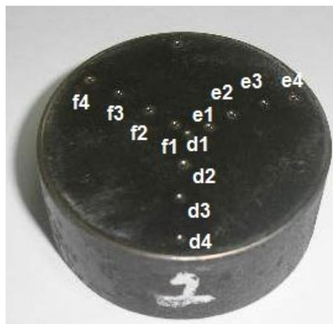
Figura 4.9 – Destaque da impressão das calotas esféricas obtidas no ensaio de dureza
