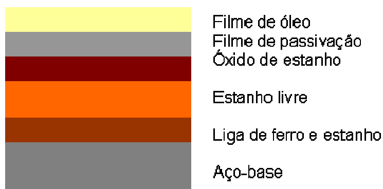
Figura 3.1 - Forma de Revestimento das folhas Flandres Fonte: Indústrias Reunidas Renda (2010).
