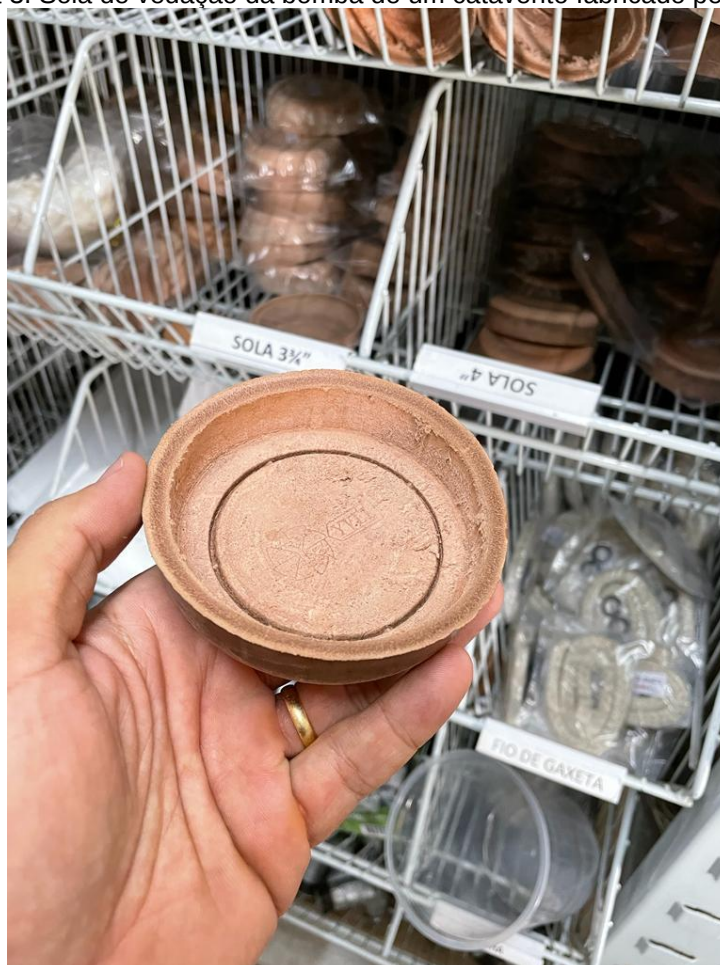
Figura 3. Sola de vedação da bomba de um catavento fabricado pela Yvel.
