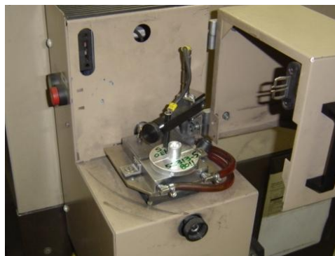
Figura 3.1 Espectrômetro ARL 3460 AES Figura 3.2. Corpos de prova modelo ASTM 307
