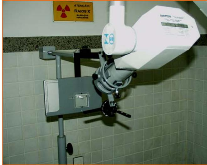
**Figura 17:** Aparelho de raios-X Spectro 70X (Dabi Atlante), com o posicionador PTR 2000 (Fabinjet) acoplado.
