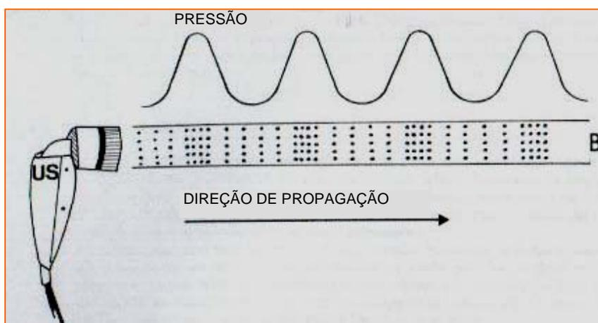
**Figura 7:** Diagrama do feixe de ultra-som com as áreas de compressão e rarefação molecular. (Zinkin, M.C. et al., *Therapeutic Ultrasound*. In: Kloth, L.C. (Col.). *Thermal Agents in Rehabilitation*. e.7, p.134-141.)
