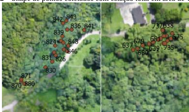
Figura 42 – Shape de pontos coletados com estação total em área de vegetação.
