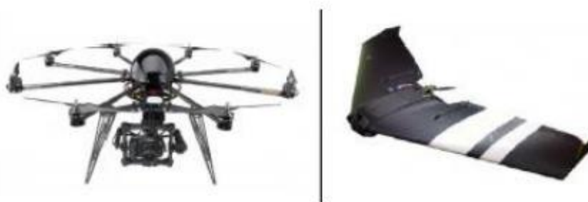
Figura 2 – Modelos de VANT: asa rotativa (esquerda) e asas fixa (direita).
