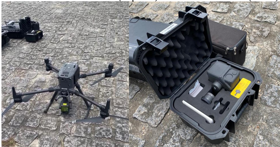
Figura 10 – VANT Matrice 300 RTK (esquerda) e LIDAR Zenmuse L1 (direita).
