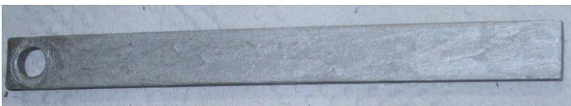
**Figura 13 – Cupom para análises das concentrações celulares e taxas de corrosão.**
