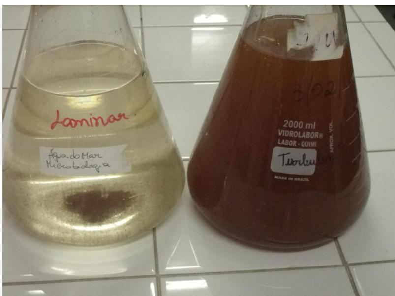
Figura 51 - Águas de saída dos *loopings* de escoamentos laminar e turbulento, após 28 dias de circulação, com adição hipoclorito de sódio e xantana (ciclo III).
