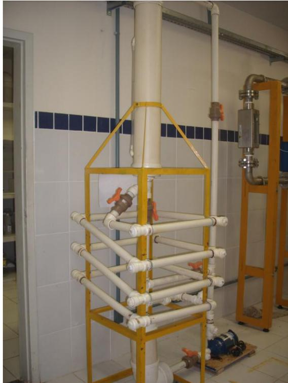
Figura 15 - *Looping* utilizado no escoamento laminar.
