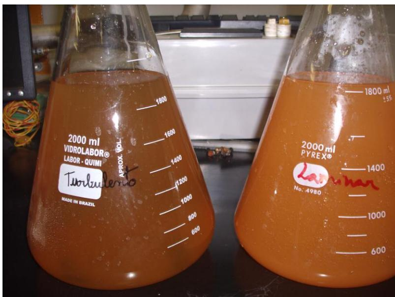
Figura 49 – Águas de saída dos *loopings* de escoamentos laminar e turbulento, após 28 dias de circulação, sem adição de agentes químicos (ciclo I, controle).
