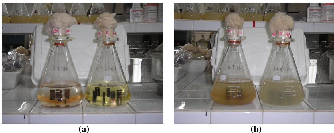
**Figura 10 - Biorreatores (a) água do mar e água salina estéreis (b) água do mar e água salina com *Pseudomonas aeruginosa*.**
