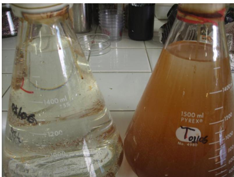
Figura 52 - Águas de saída dos *loopings* de escoamentos laminar e turbulento, após 28 dias de circulação, com adição de xantana (ciclo IV).
