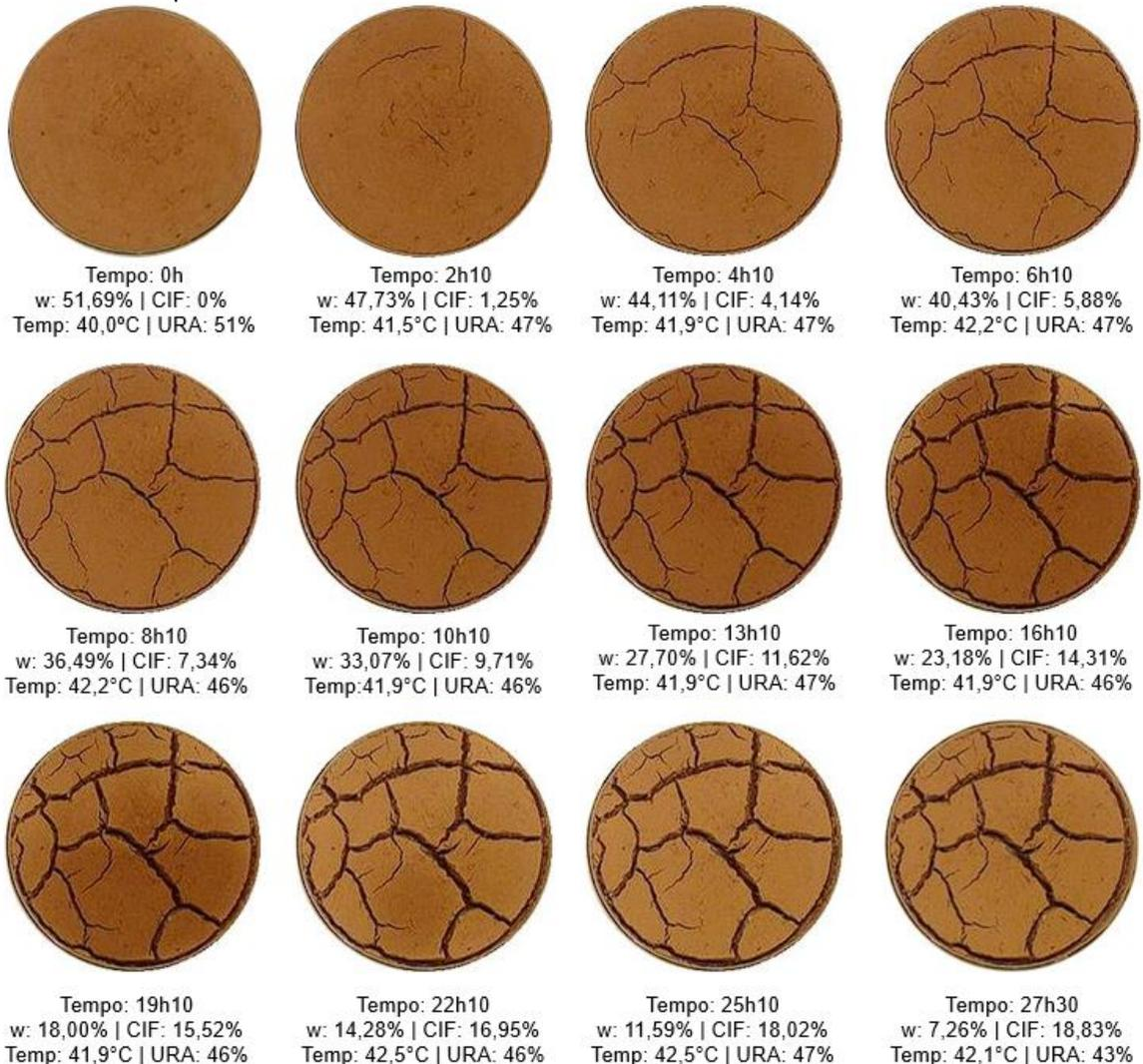
r) Relação entre CIF e umidade da amostra com 2% de fibras de pneu.
