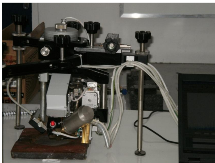
Figura 3.7 – Conjunto tubo de raios-X/detector (LABSOLDA - UFCG -PB).
