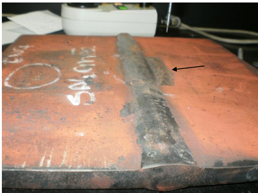
Figura 3.10 – Chapas soldadas pelo processo SAW mostrando os furos cujas coordenadas dos seus centros estão sendo mapeados na MMC.
