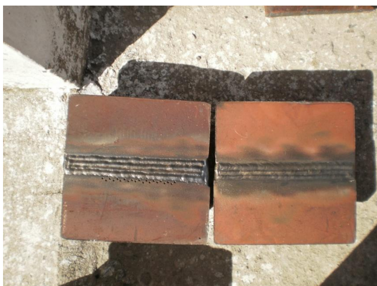
Figura 3.3 – Chapas soldadas com ângulo do bisel de 35^{\circ} e 25^{\circ} .
