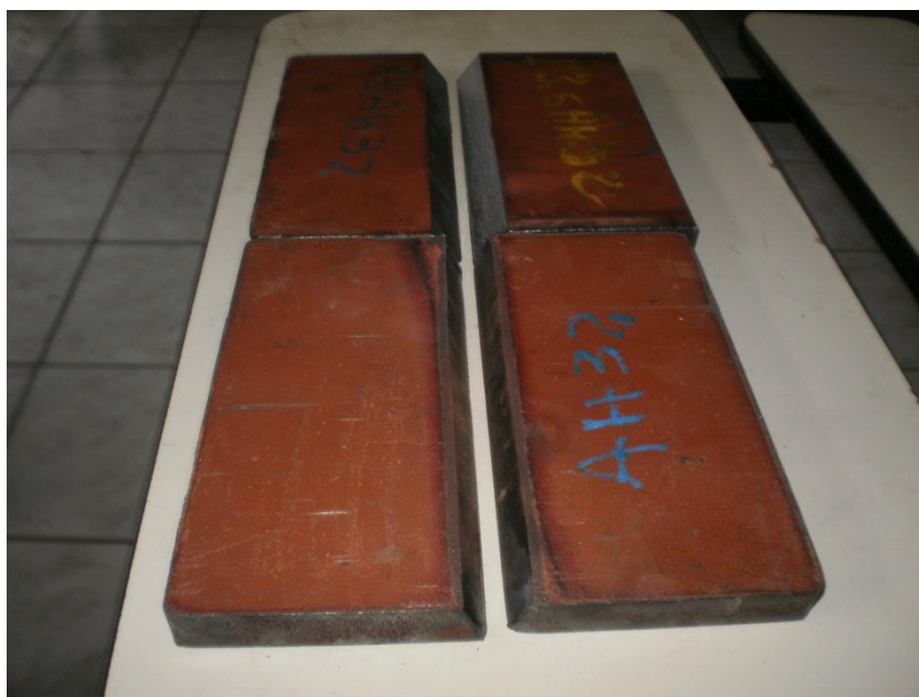
Figura 3.1 – Chapa de aço ASTM AH32, para corpo de prova.
