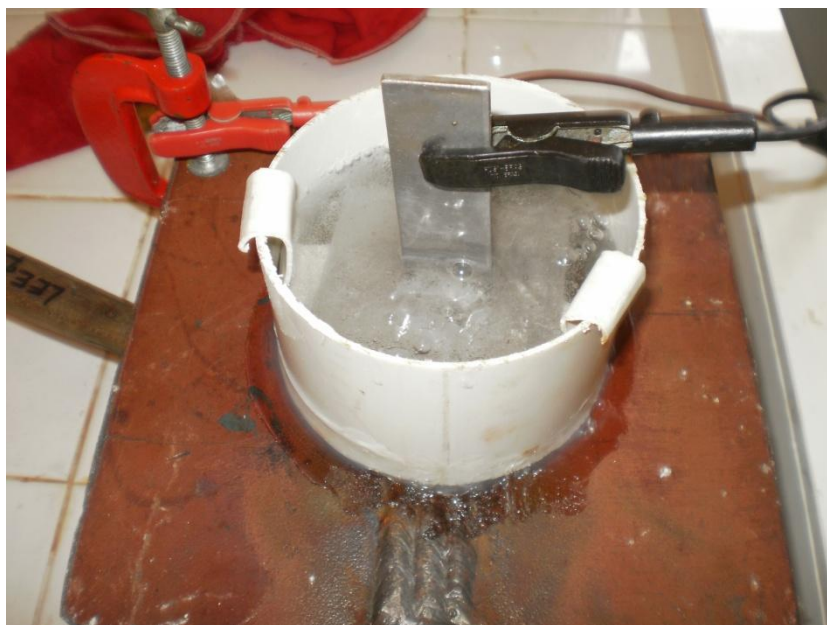
Figura 3.4 – Sistema de polimento eletrolítico (LABSOLDA - UFCG - PB).
