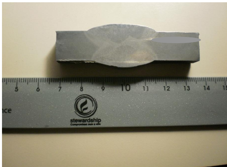
Figura 4.19 – Macroscopia da junta soldada pelo processo SAW (escala em mm).
