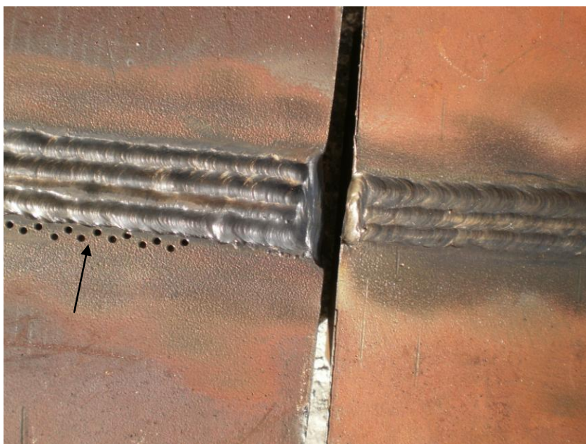
Figura 3.9 – Chapas soldadas pelo processo SMAW mostrando os furos cujas coordenadas dos seus centros serão mapeado na MMC.
