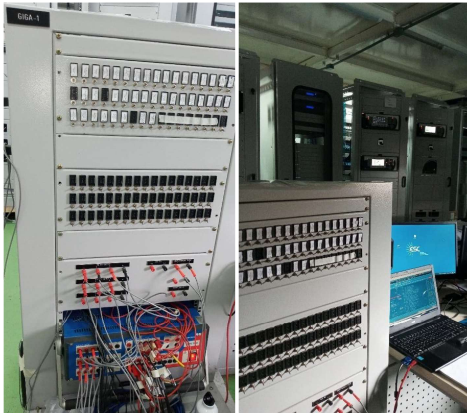
Figura 5 - Utilização de gigas e maleta de teste durante TAF.
