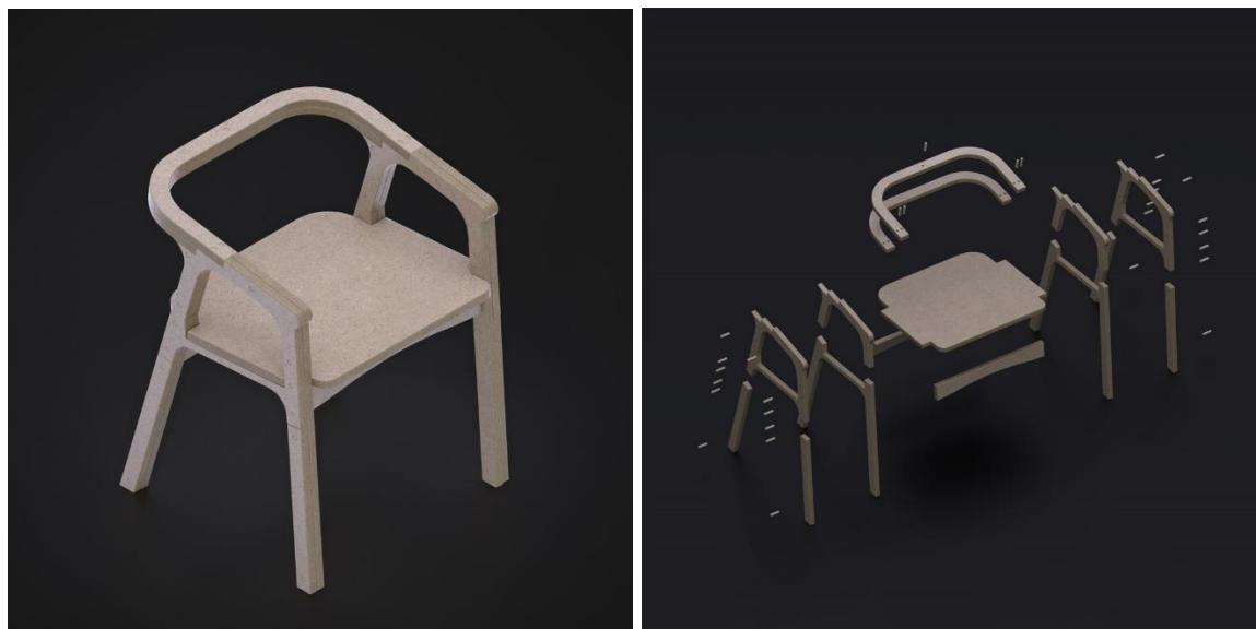
Figura 57 – Modelagem final propositiva para uso na ferramenta mediadora de Web AR. Esquerda: visualização da cadeira de compensado. Direita: vista explodida do modelo 3D.
