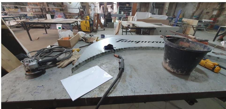
Figura 49 – Estação de usinagem, Baluarte. Na imagem, impressão A4 extraído do DT para confecção da peça.
