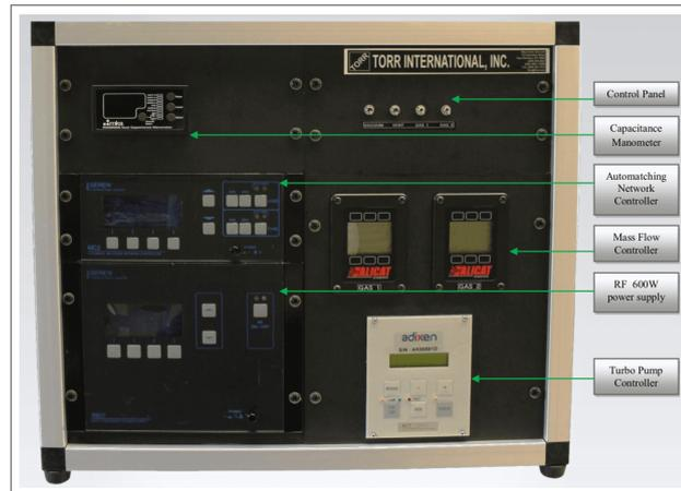
Fonte: figura retirada de <http://www.torr.com/reactive-ion-etcher-system>
