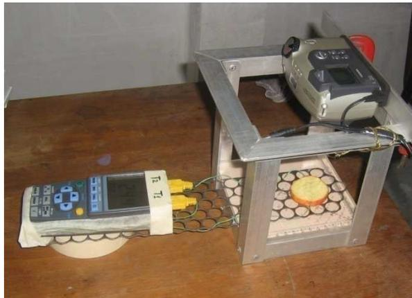
Figura 3.75. Instrumento para planimetria do diâmetro da amostra
