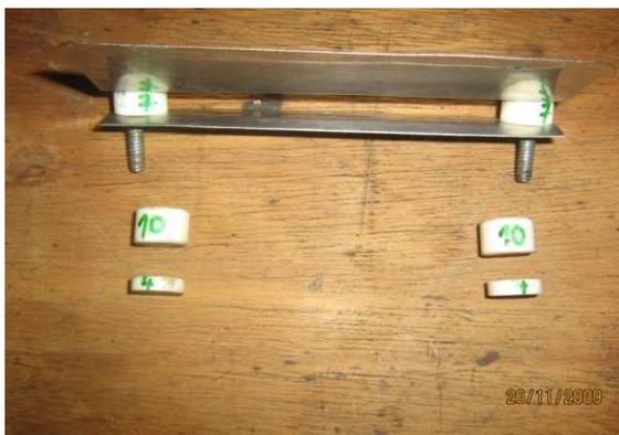
Figura 3.17. Cortador de caju com lâminas ajustáveis.
