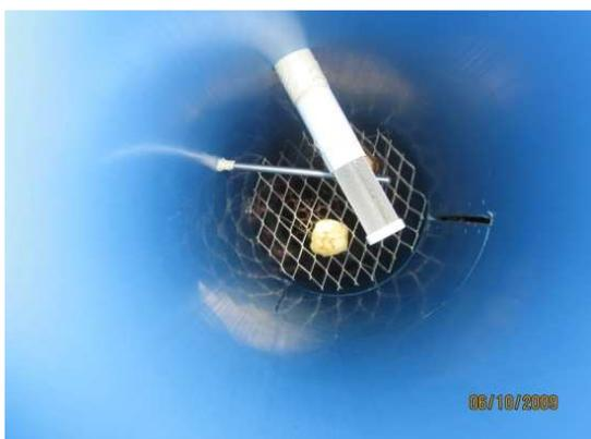
Figura 3.10. Termo-higrômetro interno.
