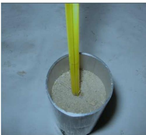
Figura A1. Termômetro de referência dentro de recipiente com areia.
