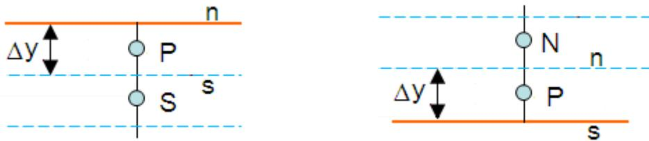
Figura 5.4 Representação da malha para o volume de fronteira superior e inferior.
