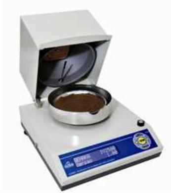
Figura 3.19. Balança termogravimétrica
