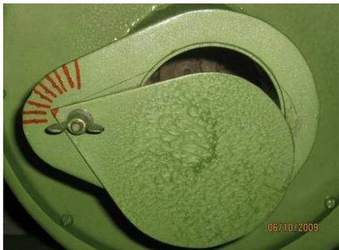
Figura 3.4. Dumper de controle da vazão do ar de secagem
