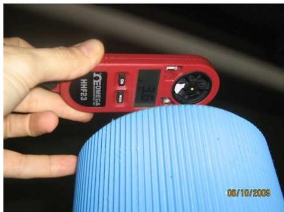
Figura 3.12. Anemômetro, para medições de velocidade do ar.
