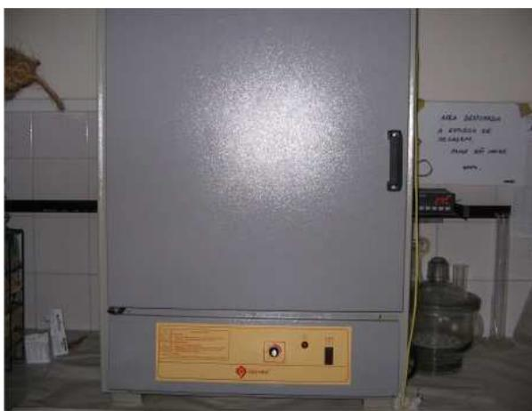
Figura A2. Estufa QUIMIS utilizada na calibração de termopares.
