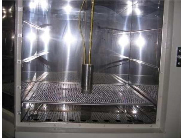
Figura A3. Esquema da calibração de termopares utilizando a estufa.
