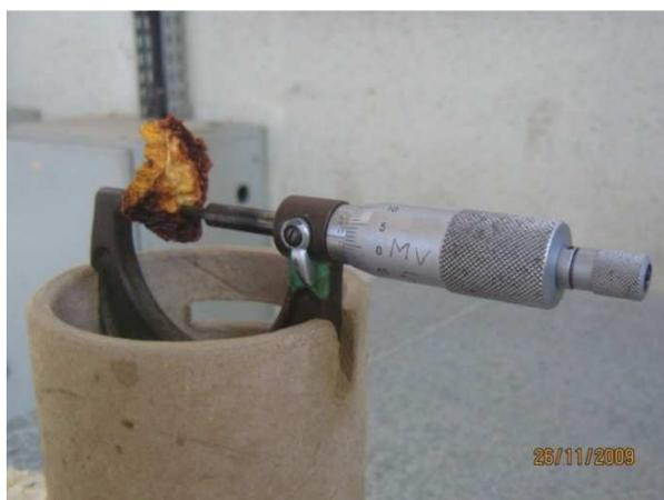
Figura 3.76. Instrumento para planimetria da espessura da amostra
