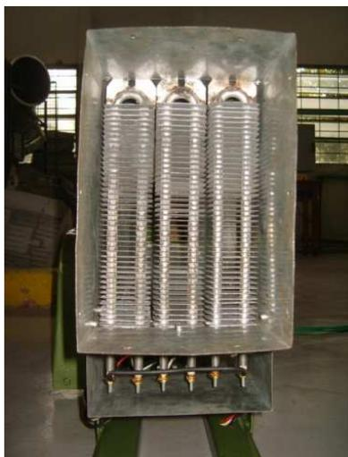
Figura 3.6. Conjunto de resistências com 3 kW totais
