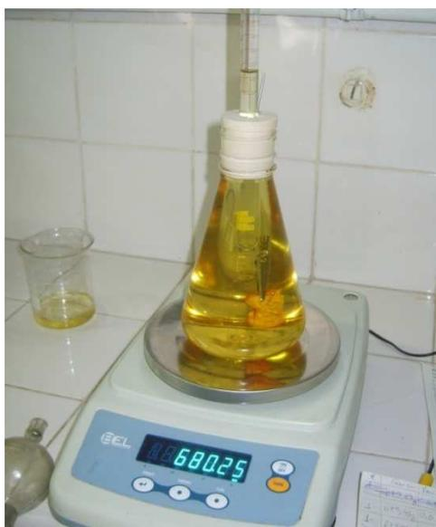
Figura 3.73. Medições para obter a densidade.
