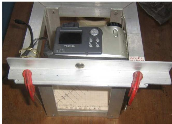
Figura 3.16. Detalhe da máquina fotográfica no planilhmetro.
