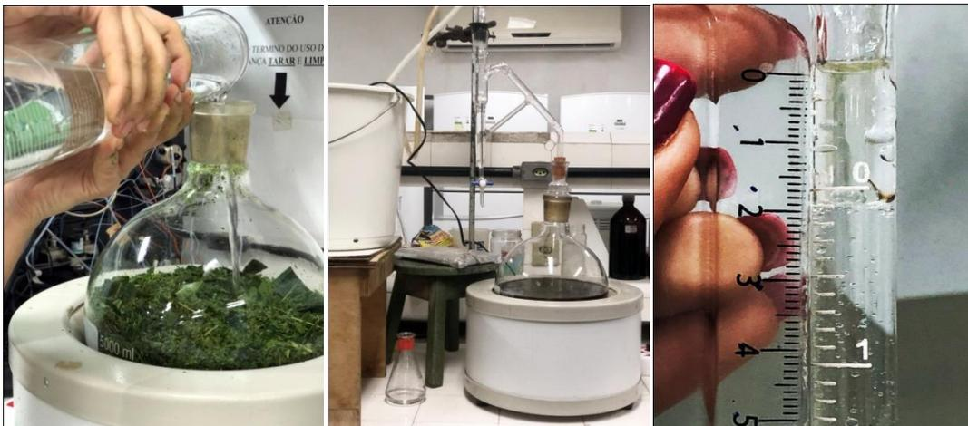
Legenda: Primeira fotografia da esquerda: colocação da água; fotografia central: Sistema em funcionamento e terceira fotografia à direita: medição com uma régua do volume de água.
