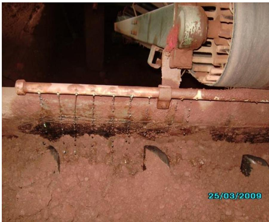
**Figura 64 - Foto da posição do cano de água no misturador**
