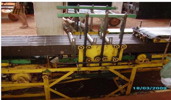
**Figura 79 - Foto da mesa de corte automático**
