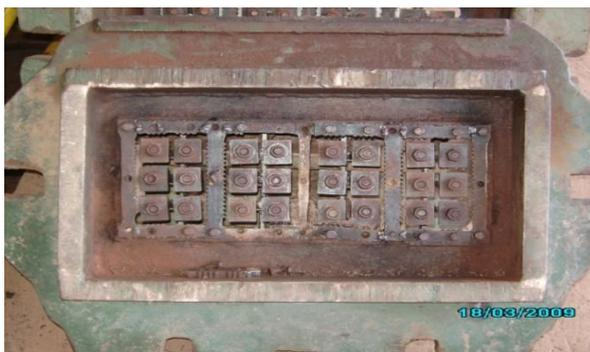
**Figura 78 - Foto da boquilha de aço**
