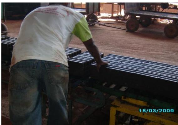
**Figura 84 - Foto do carregamento/descarregamento manual da esteira depois do corte**
