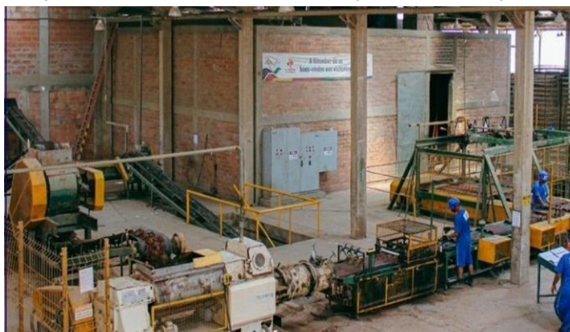
Figura 3 – Arranjo físico do setor de extrusão da telha paulistinha na empresa estudada
