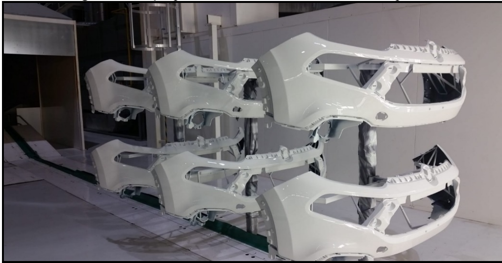
Figura 10 - Peças pintadas saindo do forno da cabine de pintura
