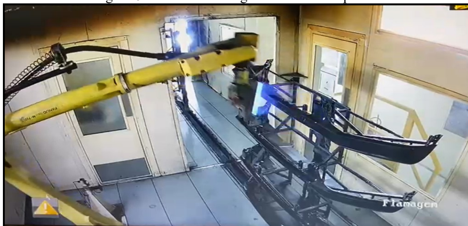
Figura 6 - Processo flamagem na cabine de pintura
