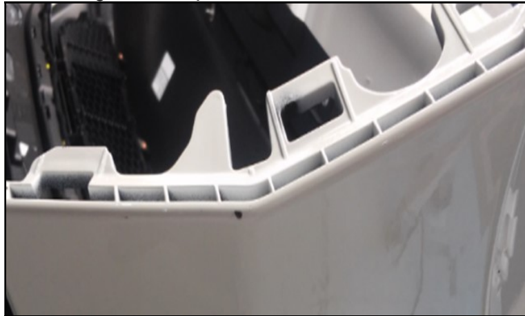
Figura 21 - Peça danificada devido uma batida
