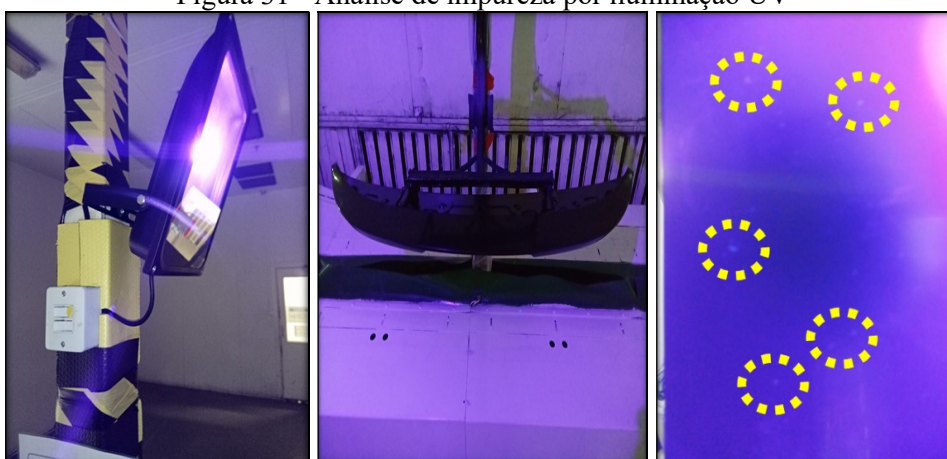
Figura 31 - Análise de impureza por iluminação UV
