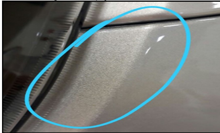
Figura 15 - Peça pintada com manchas
