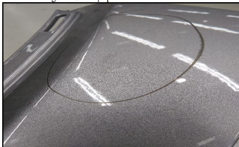
Figura 20 - Peça pintada com falta de base
