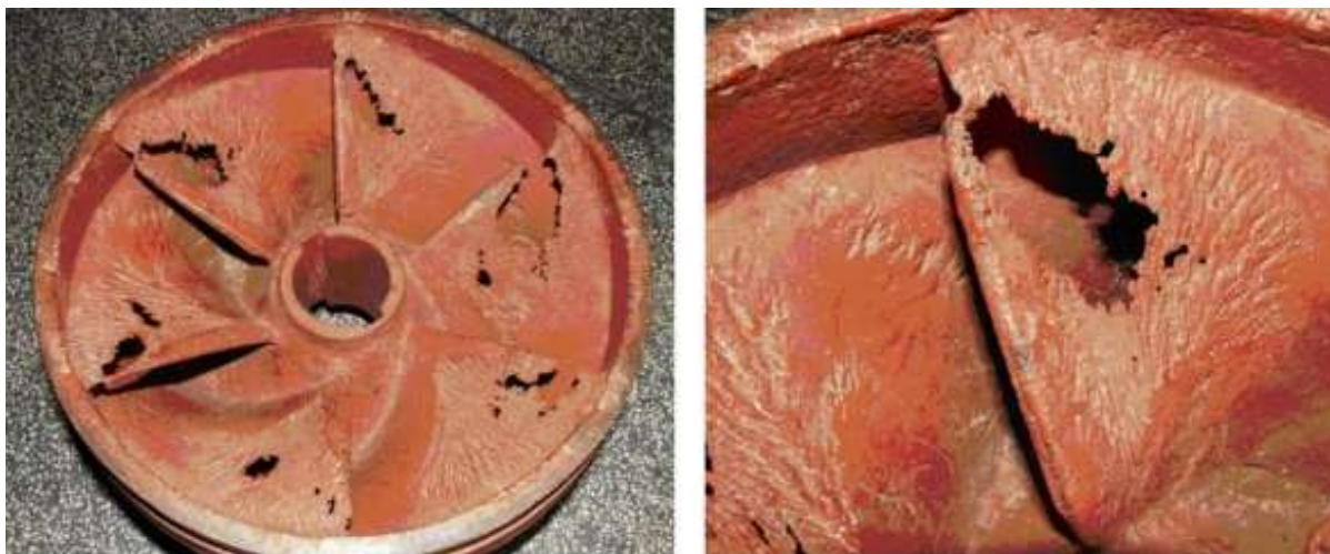
Figura 7 - Rotor de bomba centrífuga danificado pela cavitação.
