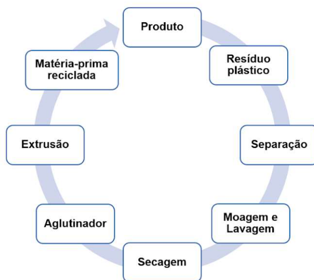
Figura 4 - Simplificação do processo de reciclagem do plástico
