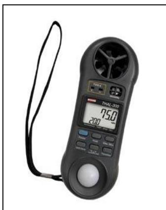
Figura 2.1 Termo-Higro-Anemômetro Luxímetro Digital THAL-300. Fonte: INSTRUTHERM (2010)
