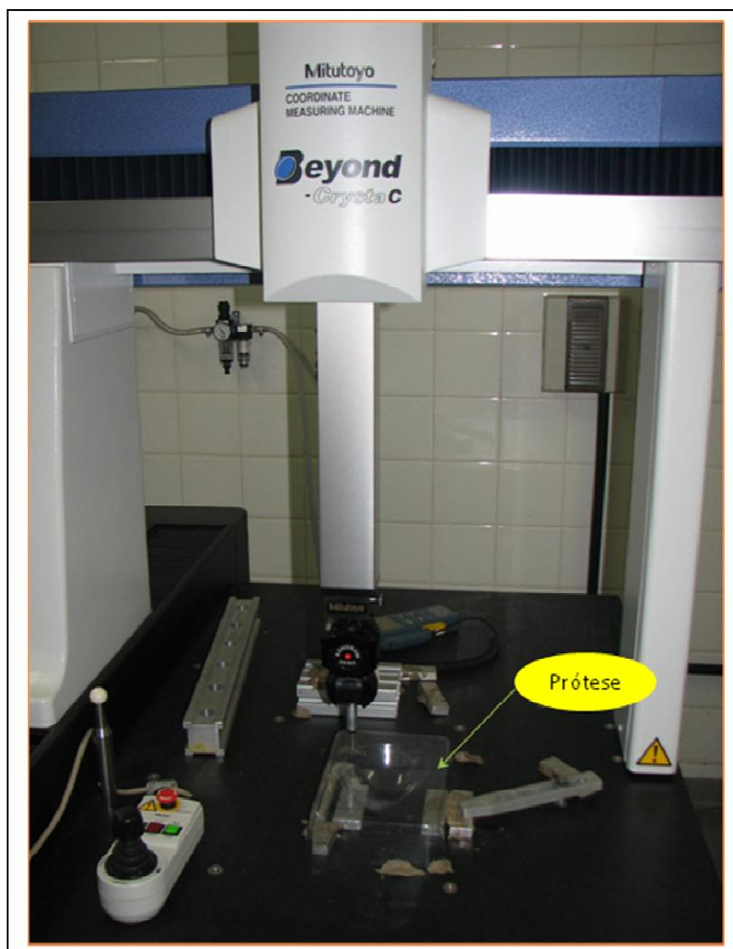
Figura 2.4 Máquina de Medição por Coordenadas CRYSTA 574
