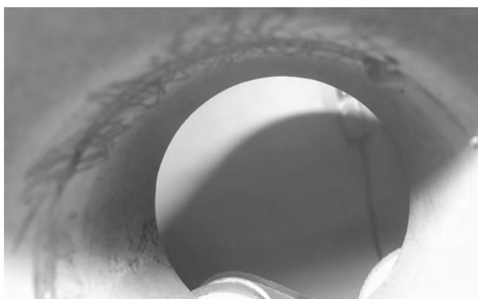
Figura 4.6 - Foto da junta AR1, 2º quadrante, vista interna da raiz da solda (Arame Metálico).
