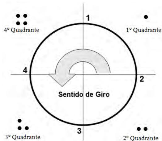
Figura 3.13 - Identificação dos quadrantes marcados nas juntas soldadas.
