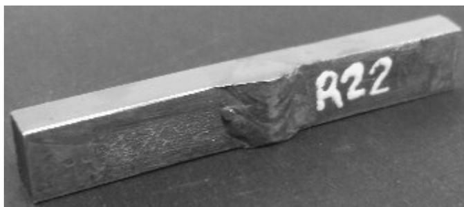
Figura 3.20 - Foto do corpo de prova para macrografia, micrografia e microdureza.
