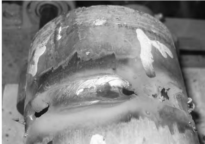
Figura 4.1 - Foto da junta onde observa-se a perfuração das bordas da junta.
