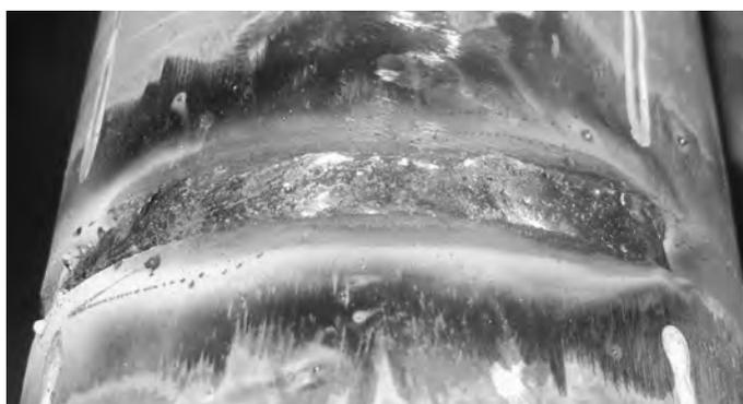
Figura 4.5 - Foto da junta AR1, 2º quadrante, vista externa da raiz da solda (Arame Rutílico).
