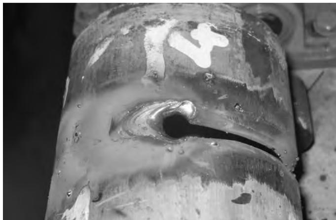
Figura 4.2 - Foto da junta onde observa-se a perfuração do material de base.
