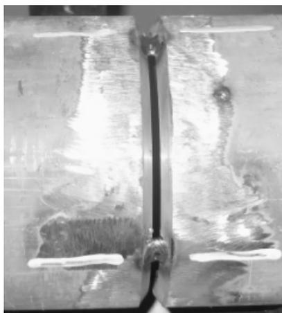
Figura 3.12 - Foto acoplamento das juntas feito por pontos de solda.
