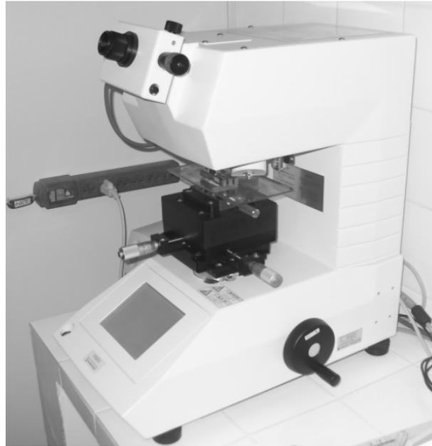
Figura 3.23 - Foto do microdurômetro Shimadzu.
