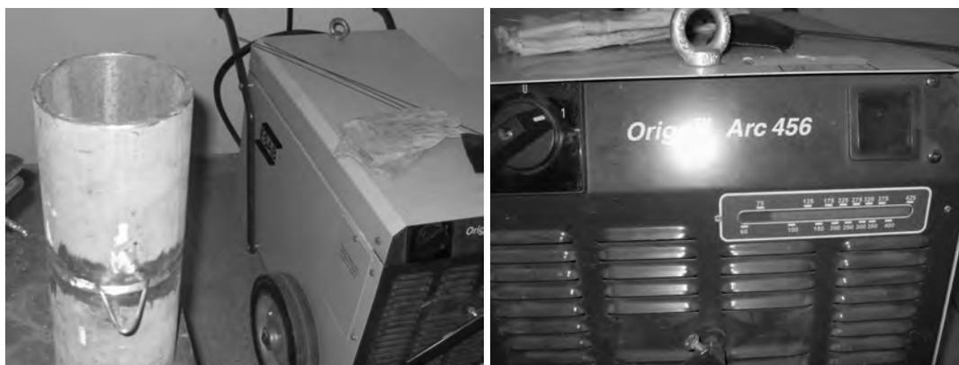
Figura 3.6 - Fotos do retificador Origo Arc 456 da ESAB, utilizado para soldagem das raízes das juntas com TIG.
