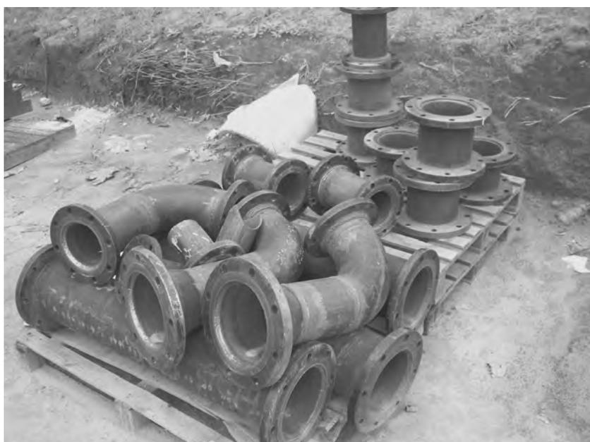
Figura 1.2 – Pequenas peças tubulares “spools” soldas num canteiro de obras (pipe shop), fonte Vórtice Engenharia.
