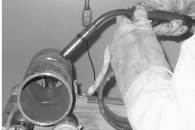
Figura 3.17 - Foto da tocha na posição de soldagem 5G (giro anti-horário).
