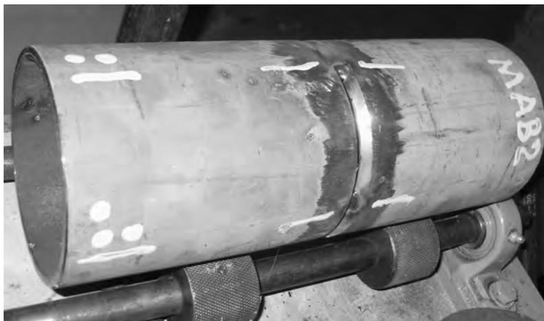
Figura 3.1 - Foto destacando as marcações da junta (junta nº 2 soldada com arame tubular “metal cored” - AB2)
