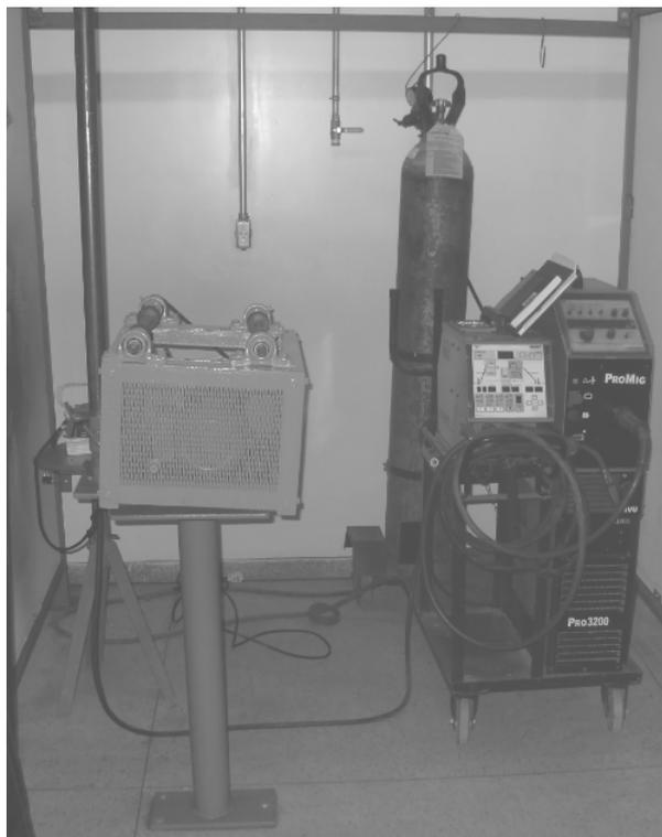
Figura 3.10 - Foto do conjunto Girador e Estação de Solda
