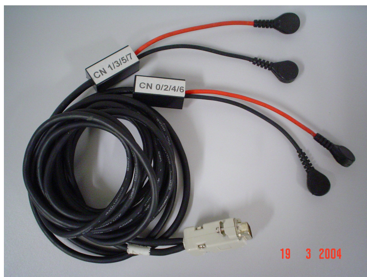
Figura 2 - Cabos com pré-amplificadores incorporados.
