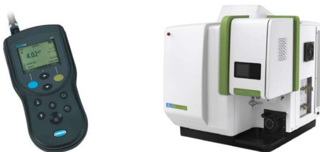
Figura 3.17 - Na esquerda, imagem ilustrativa do equipamento Multiparâmetro portátil HQ40d da fabricante Hach, utilizado para obtenção dos parâmetros Físico-Químicos, e na direita, Espectrômetro de emissão óptica com plasma acoplado indutivamente, utilizado no indicativo dos minerais.
