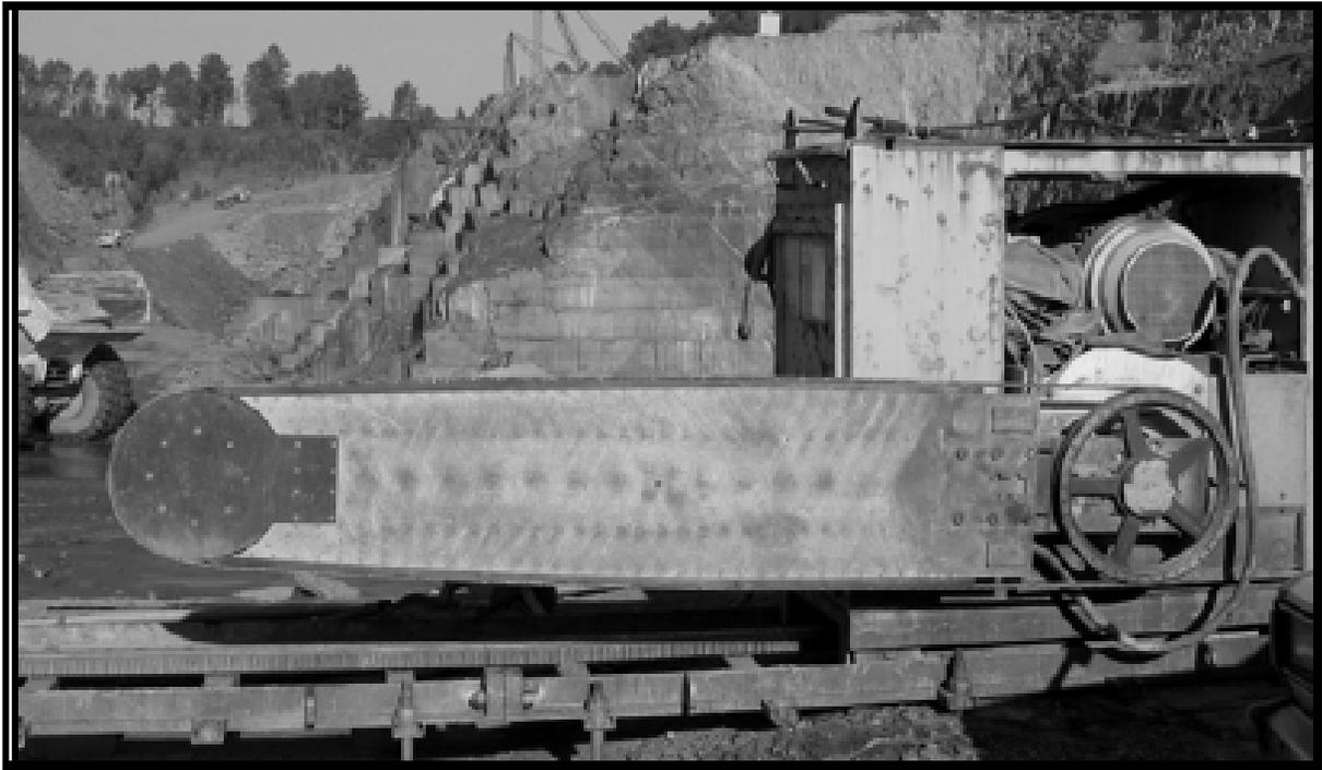
Figura 27 – Cortadeira de braço com cinta diamantada.
