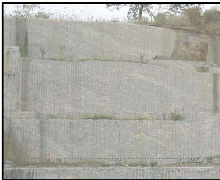
Figura 16 – Corte com perfuração e utilização de argamassa expansiva, Sítio Jaú, Sertânia – PE.
