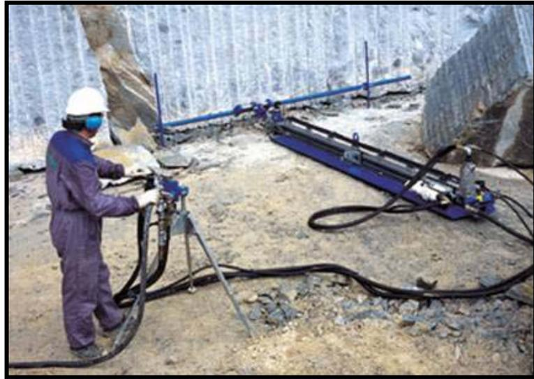
Figura 18 – Perfuração coplanar horizontal.
