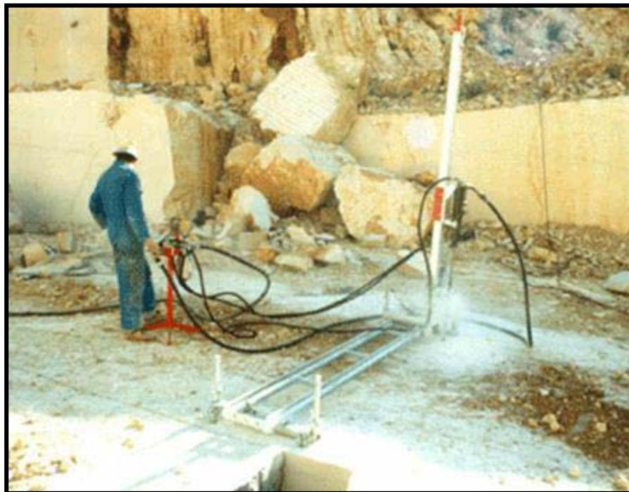
Figura 19 – Perfuração coplanar vertical.
