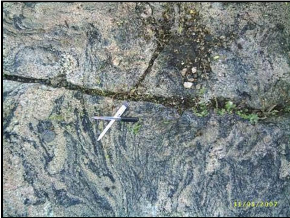
Figura 10 – Fraturas naturais no maciço rochoso, adequadas para o uso de lavra seletiva.
