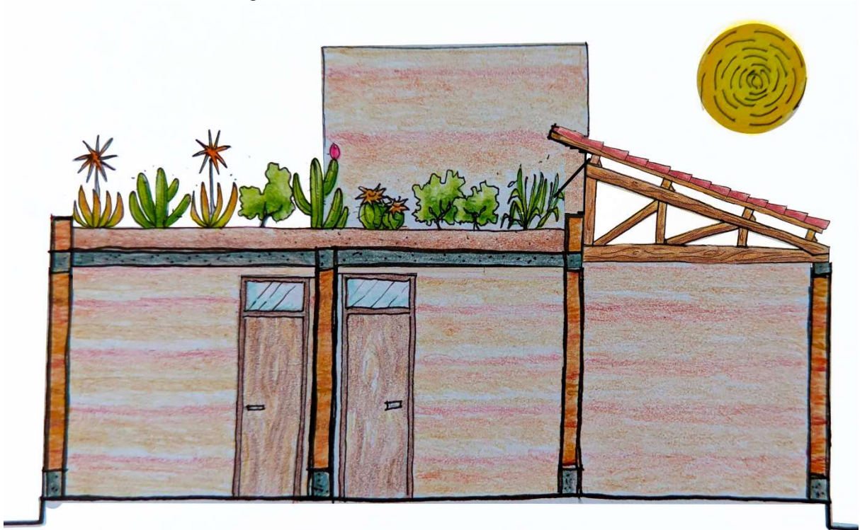
Figura 67: Corte mostrando a estrutura das cobertas.
