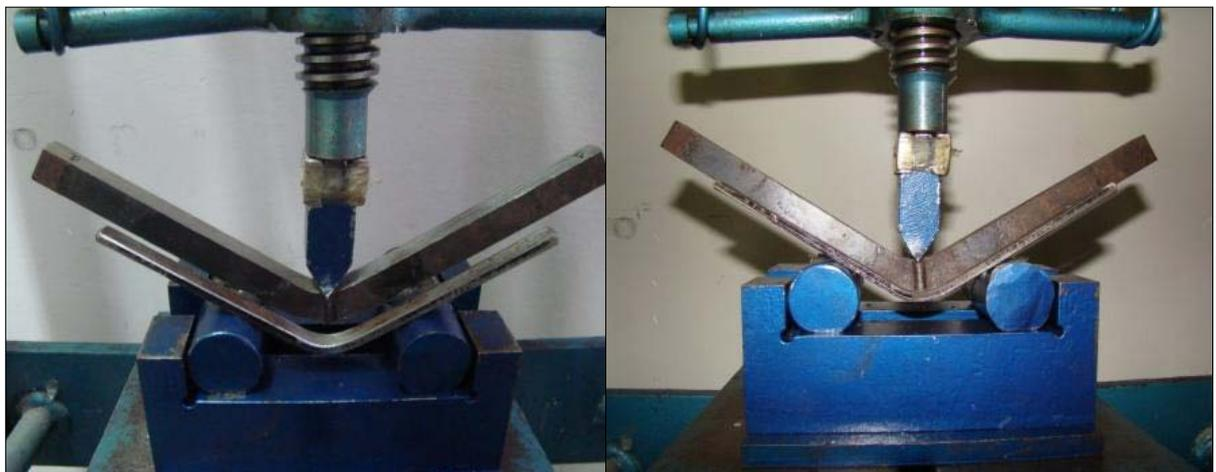
Figura 4.14 – Fotografia do ensaio de dobramento com gabarito em ângulo de  $120^\circ$ .
