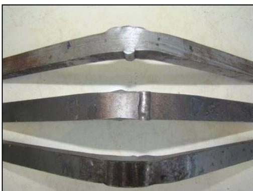
Figura 5.33 – Dobramento FCAW-G na ausência de ventos.
