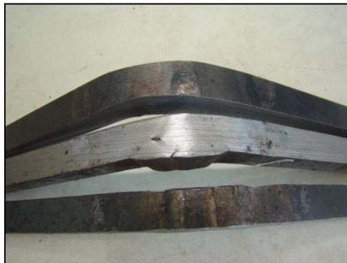
Figura 5.34 – Dobramento FCAW-S na ausência de ventos.
