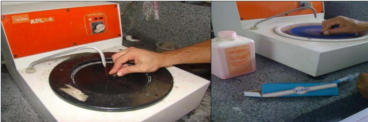
Figura 4.11 – Preparação do corpo de prova para análise microestrutural.
