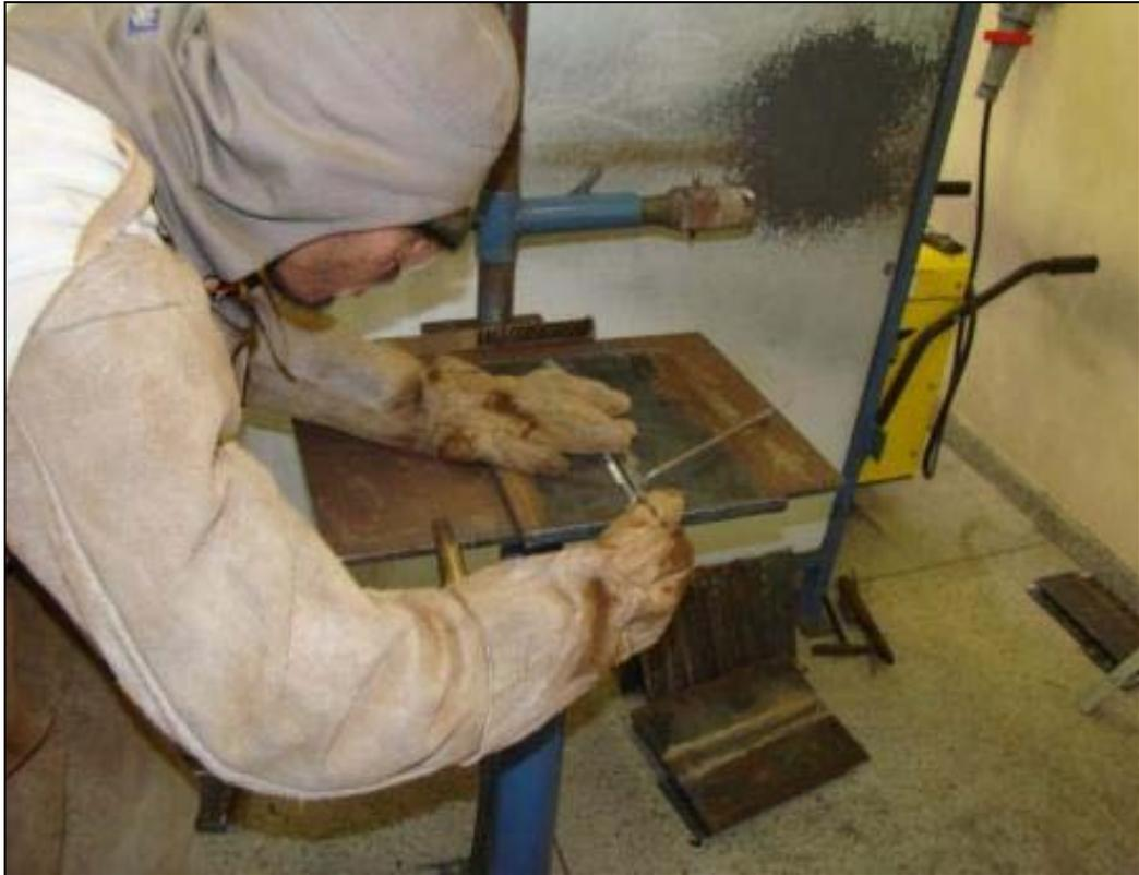
Figura 4.1 – Fotografia da preparação das duas chapas de aço de classificação ASTM A36, com dimensões 300 mm x 100 mm x 12,7 mm cada.
