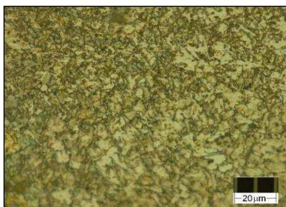
Figura 5.12 – Micrografia da ZF Centro - FCAW-G ausência de ventos (Aumento 1000x)
