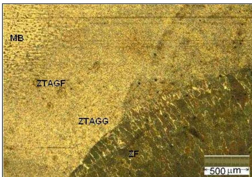
Figura 5.9 – Micrografia da Zona Termicamente Afeta - FCAW-G na ausência de ventos (Aumento 50x)
