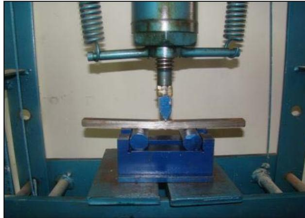
Figura 4.13 – Fotografia da prensa manual hidráulica utilizada para o ensaio de dobramento.
