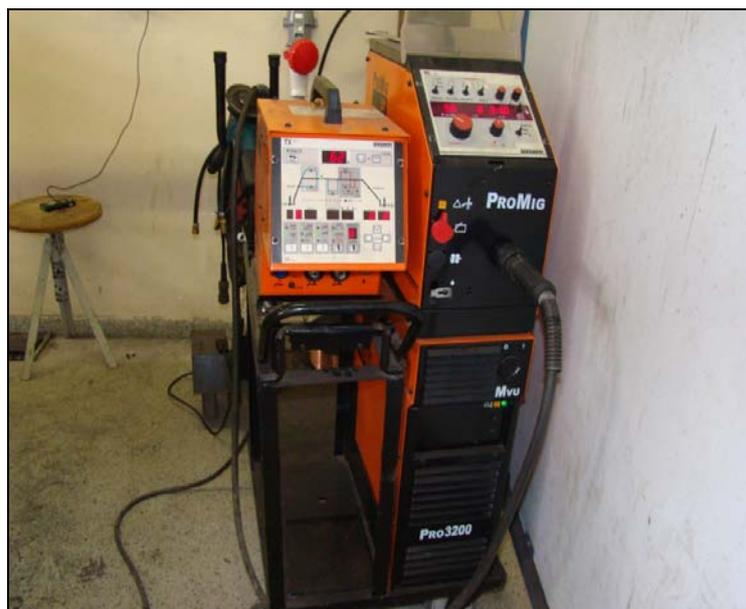
Figura 4.2 – Equipamento de soldagem - Kemppi Pro Evolution 3200.
