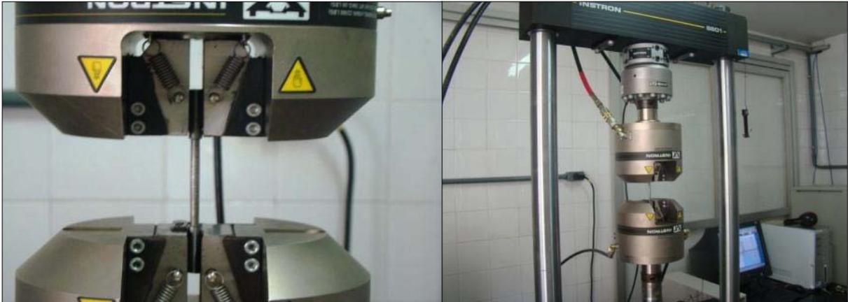
Figura 4.15 – Fotografia da máquina de ensaios universal utilizada nos ensaios de tração.
