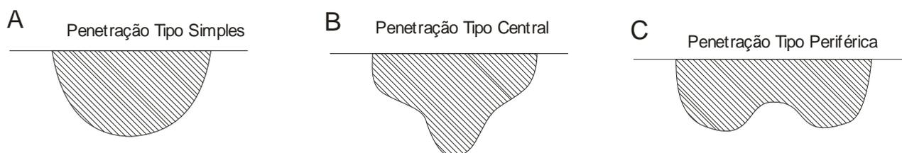
Figura 2.9: Três tipos de penetrações de soldagem em uma seção transversal
