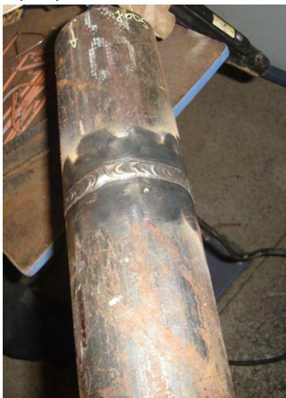
Figura 2.11: Junta 005 logo após a soldagem.
