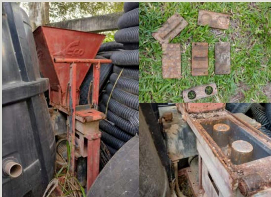
(F21) Prensa hidráulica de tijolo ecológico, fôrmas para fabricação das peças dos tijolos da comunidade Vila Verde Turmalina. Fonte: Fotos capturadas pela autora.
