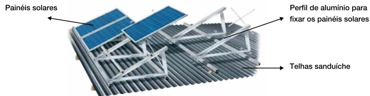
(F73) Esquema de instalação e fixação de painéis solares. Fonte: Hyspex.
