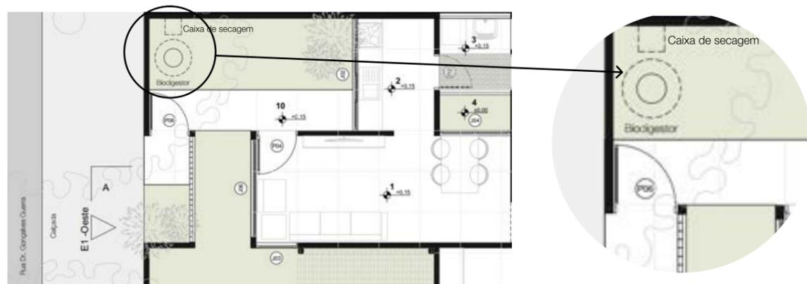
(F70) Recorte da planta tipo com indicação do biodigestor. Fonte: Autoria da autora.
