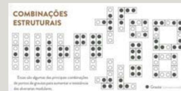
(F18) Combinações estruturais possíveis em obra com tijolos ecológicos. Fonte: Manual de Boas Práticas da Execução de Alvenaria Modular de Solo-cimento - Universidade Estadual de Minas Gerais (UEMG)
