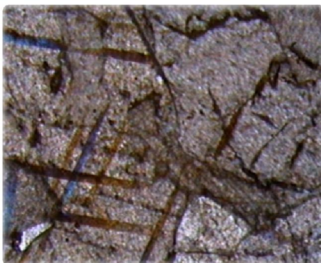
Figura 4.11 - Aspecto petrográfico da superfície de mármore branco, de placa exposta ao intemperismo durante 5 anos. Notar o preenchimento de clivagens da calcita (óxidos de Fe e/ou particulados finos em geral), e a perda de reflectância da superfície, comparada com a figura 4.10. LN/80x.
