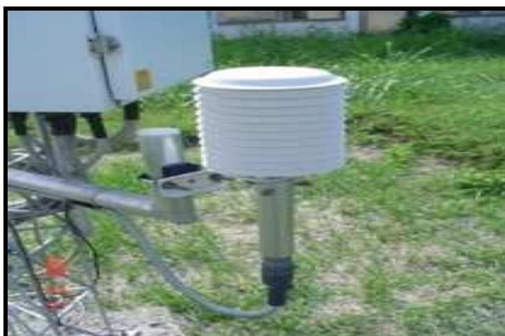
Figura 2.2 - Sensores de temperatura e umidade relativa do ar. Fonte: Laboratório de Meteorologia de Pernambuco – LAMEPE
