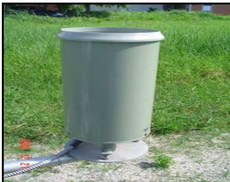
Figura 2.3 - Sensor de precipitação ou pluviômetro.
