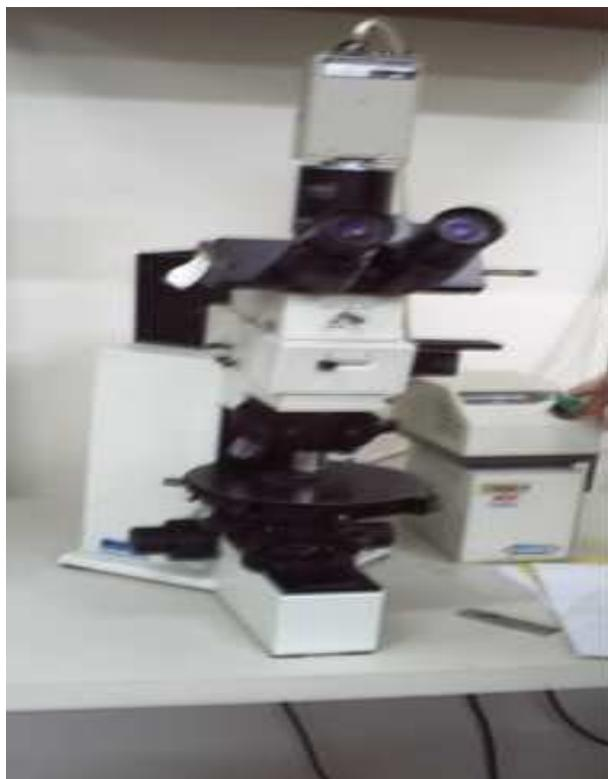
Figura 3.14: Microscópio com sistema digital micrografica, utilizado na análise petrográfica.
