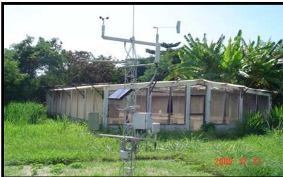
Figura 2.1 - PCDs (Plataformas de coleta de dados – localizada no bairro de San Martin, atendem a Região Metropolitana do Recife). Fonte: Laboratório de Meteorologia de Pernambuco – LAMEPE
