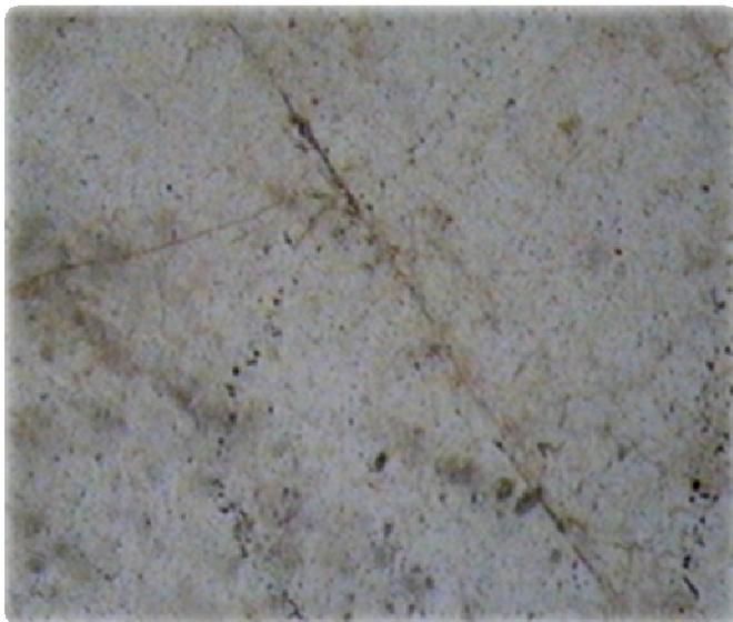
Figura 4.2 - Superfície “lisa” e pouco fissurada de feldspato do Granito Amarelo Florença, em condições de produto são (poucas evidências de alteração supergênica). LN/80x.
