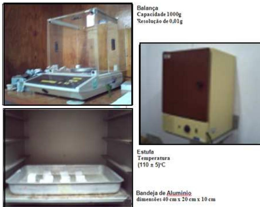
Figura 3.13 - Equipamentos utilizados na determinação dos índices físicos.
