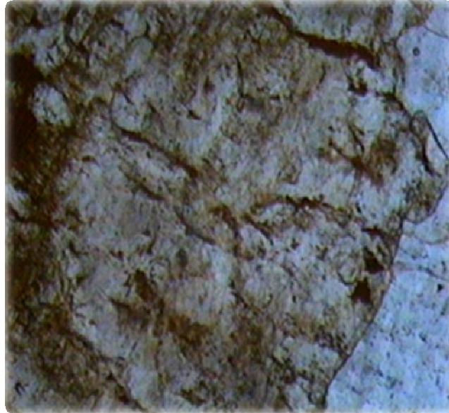
Figura 4.4 - Superfície “rugosa” com microfissuramentos difusos (alguns com preenchimento em óxidos/hidróxidos de Fe) em textura do Granito Amarelo Florença alterado. Notar o aspecto “sujo” da superfície polida. LN/80x.
