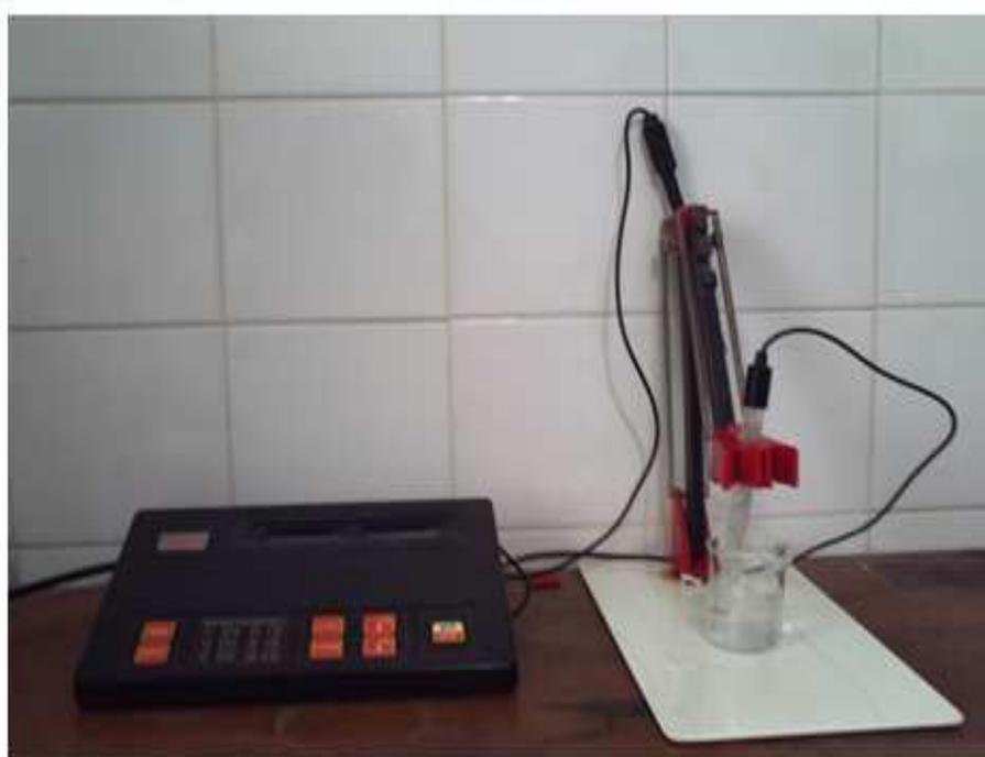
Figura 3.19 - phmêtro digital, utilizado na análise de pH
