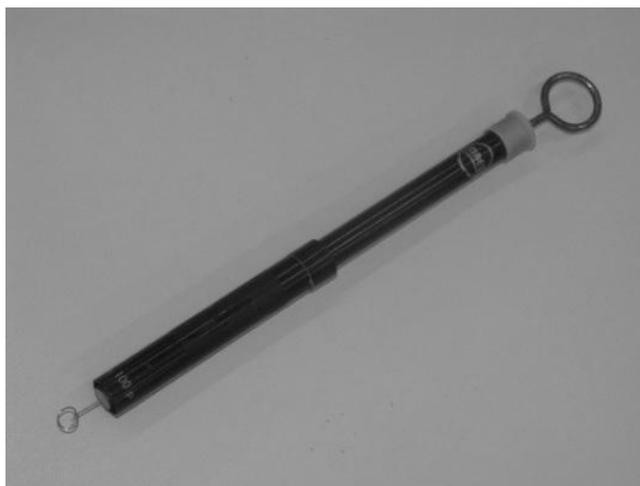
Figura 5.16 – Dinamômetro modelo MAEY utilizado no experimento.
