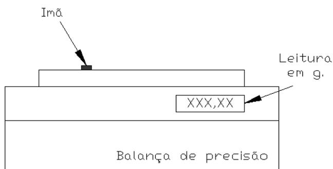
Figura 3.2 – Detalhe de fixação do ímã plataforma da balança
