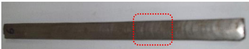
Figura 3.8 - Região pontilhada em vermelho, região esta que foram retiradas amostras para microscopia óptica e microscopia eletrônica de varredura.
