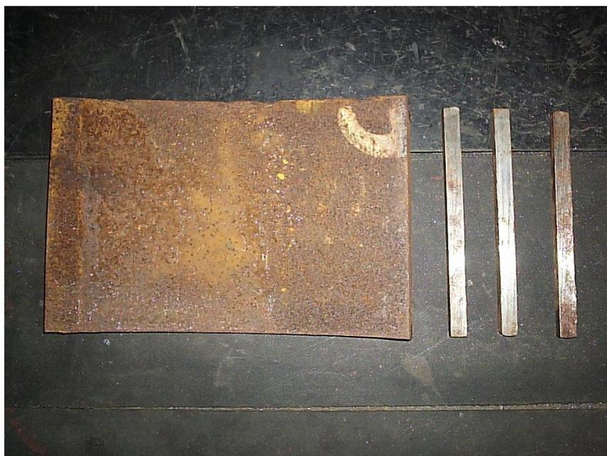
Figura 3.3 - Amostras oriundas dos cortes realizados nas chapas de aço API X70 na direção longitudinal.
