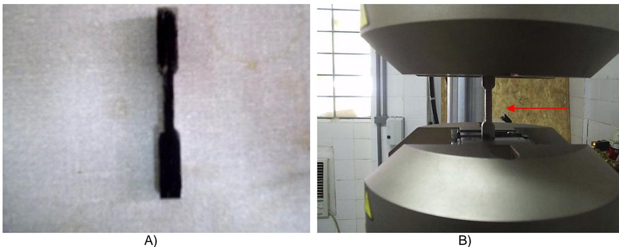
Figura 3.11 - A) corpo de prova para o ensaio de tração extraído de alguma rota térmica. B) exibindo a região de estrangulamento do corpo de prova ensaiado.
