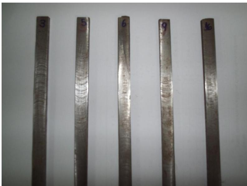
Figura 3.5 - Amostras após o processo de fresamento e identificadas com numerações para cada experimento. A seleção foi feita mediante as medidas mais próximas e sendo separadas por grupos.
