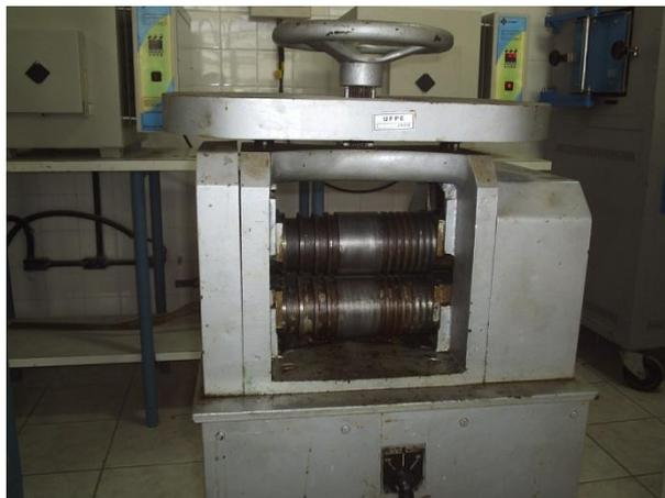
Figura 3.4 – laminador utilizado nos experimentos.
