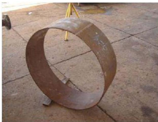
Figura 3.1 - Figura 3.1- tubo API 5L X70 cedido pela Petrobras.
