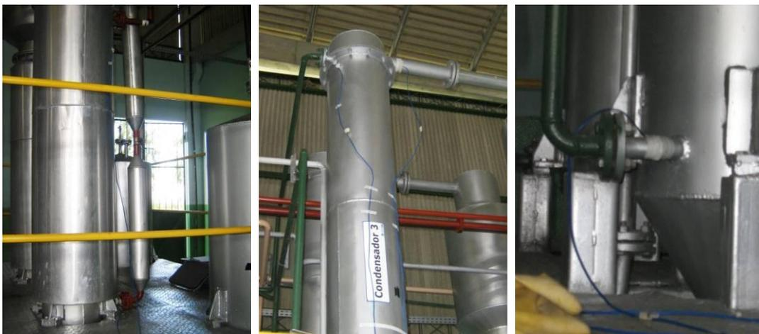
Figura 5.23 - Pontos de medição na etapa da recuperação do álcool a partir da fase pesada, medidas com termopares.
