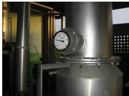
Figura 5.34 - Instrumentação própria para medição de temperatura da torre de destilação.
