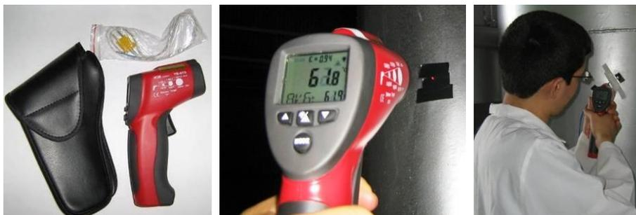
Figura 5.2 - Termômetro digital infravermelho com emissividade ajustável.
