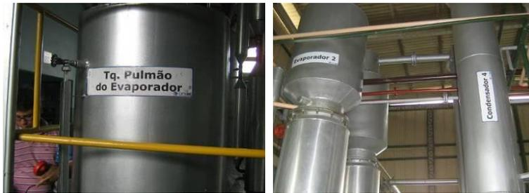
Figura 4.21 - Tanque pulmão da fase leve, evaporador 2 e condensador.
