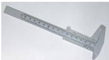
Figura 5.3 - Paquímetro.
