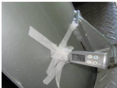
Figura 5.26 - Instrumentação própria para medição de temperatura do tanque pulmão da fase pesada.
