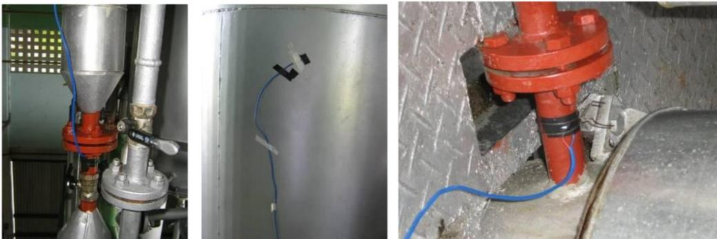
Figura 5.6 - Termopares colocados em parede e em tubulações.
