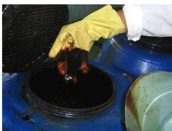
Figura 4.9 - Armazenamento da borra de neutralização.
