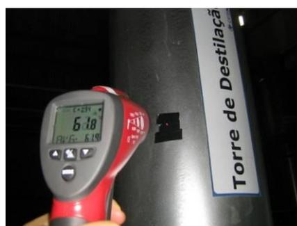
Figura 5.32 - Medição de temperatura na parede da torre de destilação com o TDIEA.
