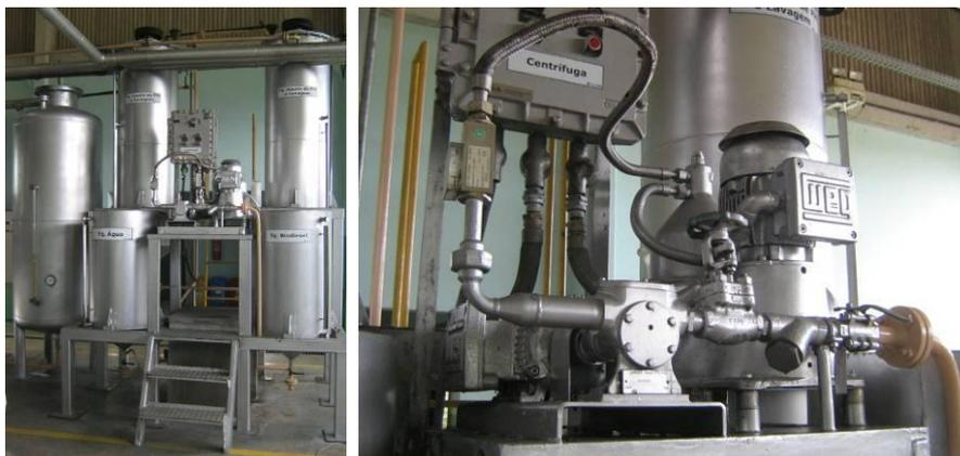
Figura 4.19 - Sistema de lavagem do biodiesel.
