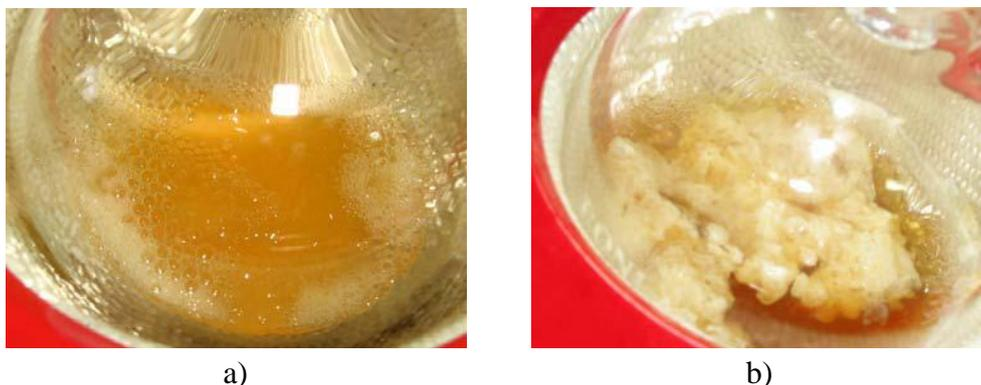
Figura 2.2 – a) Reação de transesterificação do óleo de soja com álcool anidro; b) Reação de transesterificação do óleo de soja com álcool hidratado.
