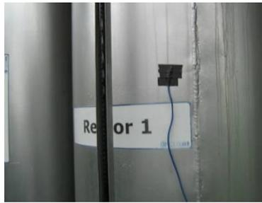
Figura 5.19 - Temperaturas medidas na parede do reator, medidas com termopares.
