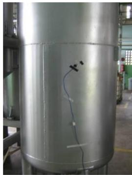
Figura 5.37 - Coleta de temperaturas na parede do desumidificador 2 com termopar.
