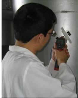
Figura 5.39 - Medição de temperaturas na parede do desumidificador 2 com TDIEA.
