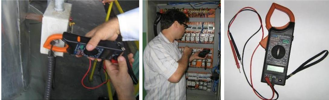
Figura 5.5 - Alicates Amperímetro.
