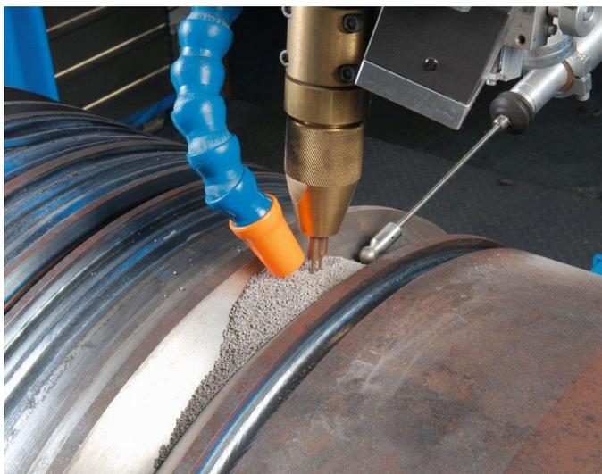
A SAW trabalha frequentemente com correntes de soldagem elevadas, que podem ser superiores a 1000 A, o que pode levar a taxas de deposição de até 45 kg/h, o que leva a necessidade, junto com a camada de fluxo, a ser utilizado na posição plana ou horizontal (para soldas de filete), além do uso conjunto com dispositivos para o deslocamento e posicionamento das peças [10].
