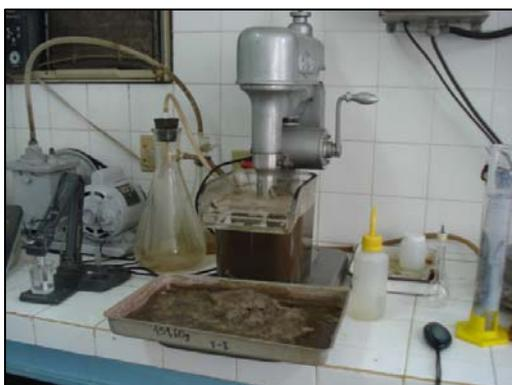
Figura 23: Célula Denver de Flotação.
