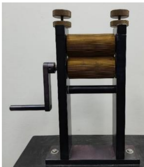
Figura 2 – Máquina utilizada para construção dos canais do monólito.
