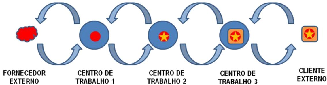
Figura 3. Funcionamento da produção em um sistema de produção enxuta, ou produção puxada. Centros de trabalho interdependentes fazem o pedido aos centros fornecedores que entregam o produto no momento em que são produzidos (fonte: autoria própria).
