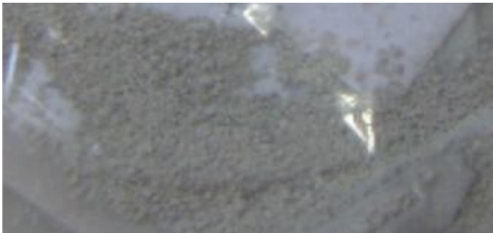
Figura 4.12 - Formação de grânulos do pó fino do polimento, proveniente do peneiramento a úmido.
