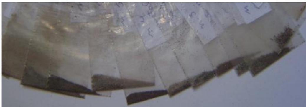
Figura 4.15 - Pó fino de serragem submetido ao separador magnético imã comum.
