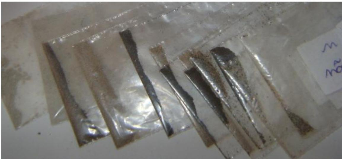
Figura 4.14 - Pó fino de serragem oriundo de peneiramento à úmido e classificado magneticamente com o uso do imã comum.
