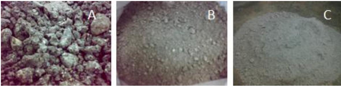
Figura 3.2 - (A) Argila; (B) Pó fino da serragem de blocos e; (C) Pó do polimento de chapas.
