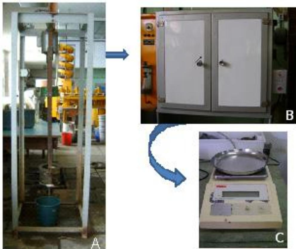
Figura 3.7 - (A) Peneirador vibratório a umido; (B) Estufa; (C) Balança de precisão Standard OHAUS.
