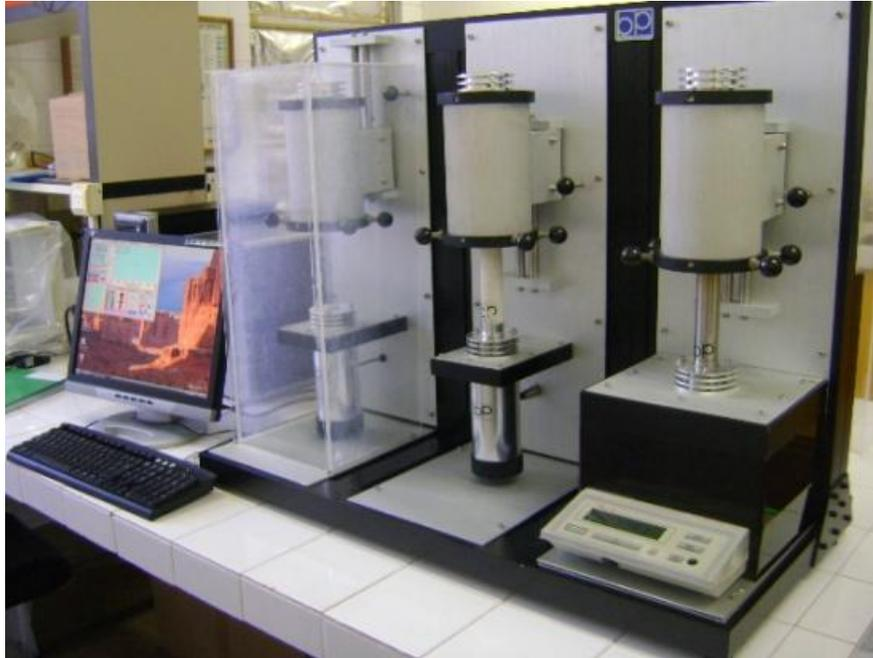
Figura 3.13 - Sistema de análises térmicas Modelo RB-3000.
