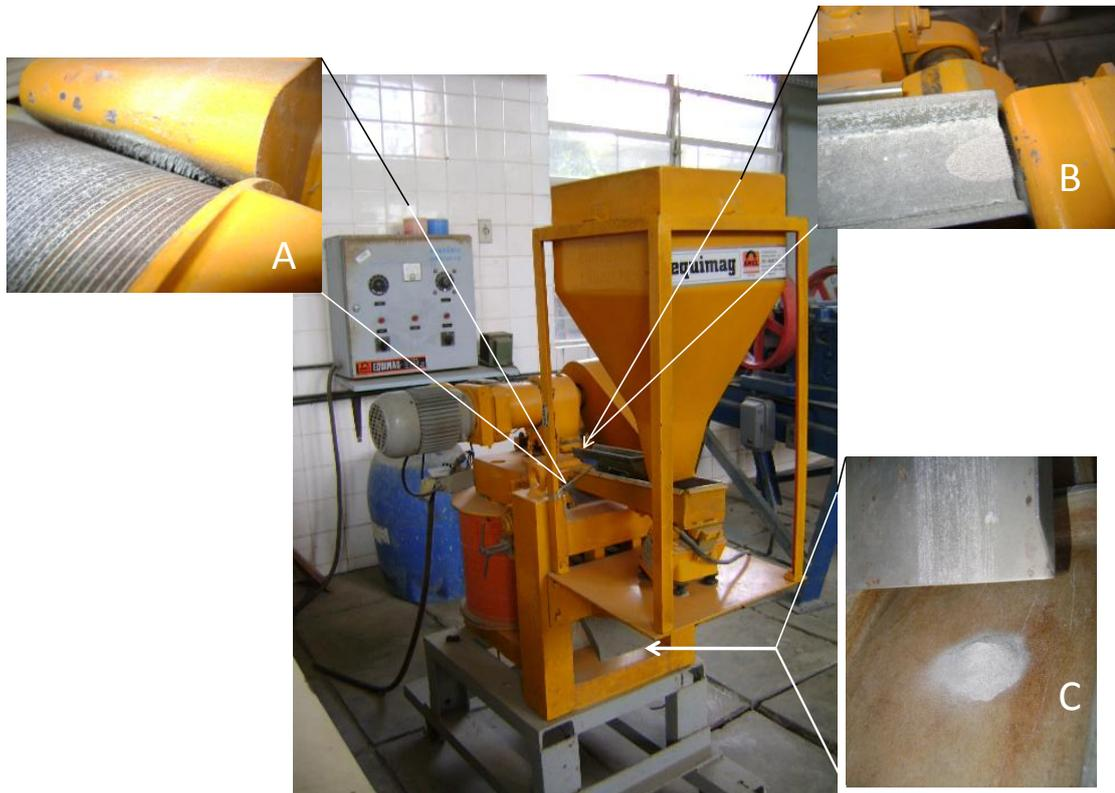
Figura 3.9 - Separador magnético de rolo induzido; (A) Detalhe do material passando no rolo; (B) Alimentação para o rolo; (C) Coleta do pó altamente magnético.
