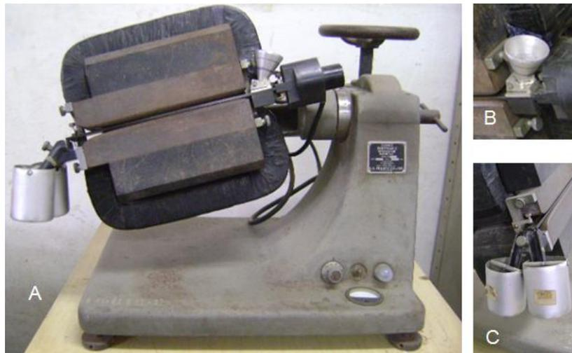
Figura 3.10 - Separador magnético Frantz; (A) Separador magnético Frantz; (B) Funil de entrada inicial do material no separador magnético; (C) Visão frontal dos coletores dos produtos metálicos e não metálicos.
