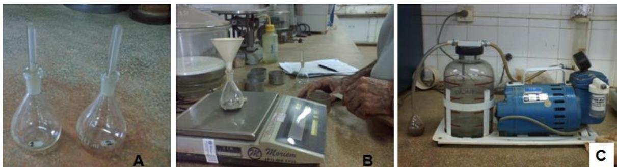
Figura 3.8 – (A) Picnômetros; (B) pesagem do solo; (C) Aspirador de ar em uso.
