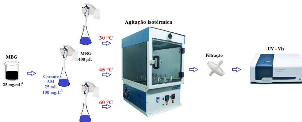
Figura 16 - Esquema experimental para avaliar a influência da temperatura sobre a remoção de AM.
