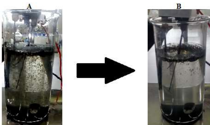
Figura 37- Formação de material gráfitico esfoliado resultante do processo OE do efluente têxtil. A) Suspensão logo após o fim da oxidação; B) suspensão após 48 h de repouso.
