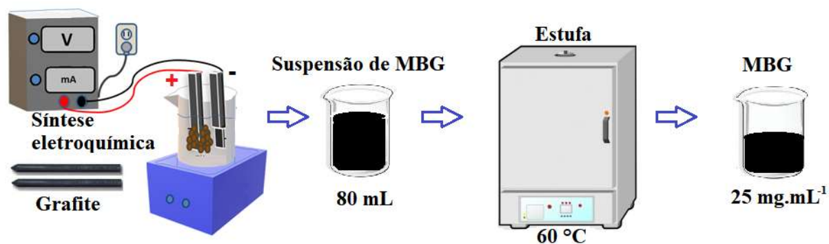
Figura 12 – Esquema geral para produção de MBG via esfoliação via esfoliação eletroquímica.
