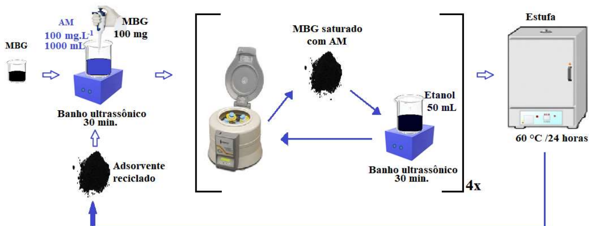
Figura 19 - Esquema experimental para avaliar a viabilidade de reuso do MBG.
