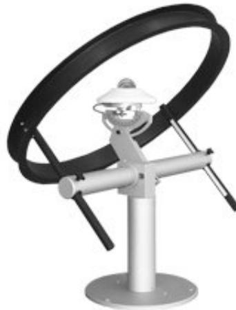
Figura 2.4: Piranômetro equipado com anel de sombra para medição de radiação difusa
