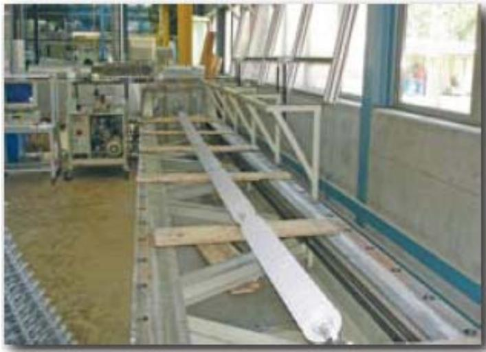
Figura 2.12 – Máquina de tração horizontal – (PFISTERER – 2009)
