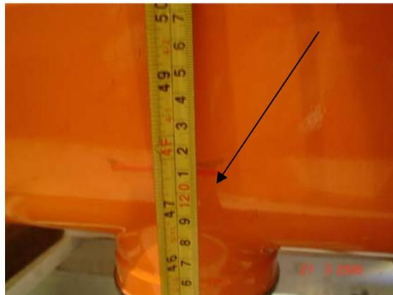
Figura. 3.10 – Medição da distância foco-filme
