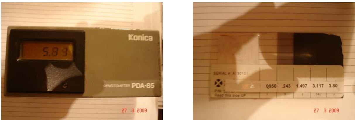
Figura. 3.19 –Densitômetro e fita densitométrica
