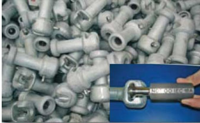
Figura 2.13 – Inspeção dimensional do terminal com passa-não-passa – (PFISTERER – 20009)
