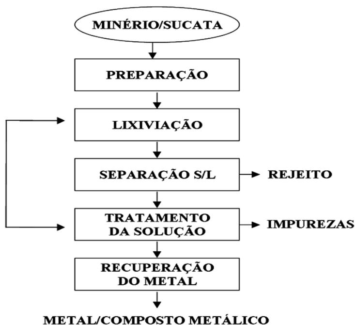
Figura 9 - Fluxograma genérico do processo hidrometalúrgico (Ciminelli, 2007).
