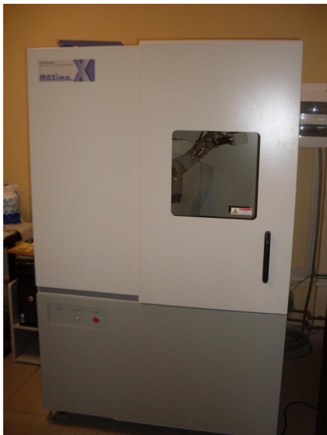
Figura 25- Difratômetro de raios-x utilizado na análise mineralógica.
