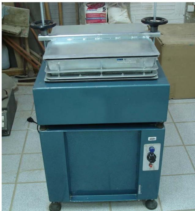
Figura 27 - Agitador de peneiras utilizado na classificação do pré-concentrado.
