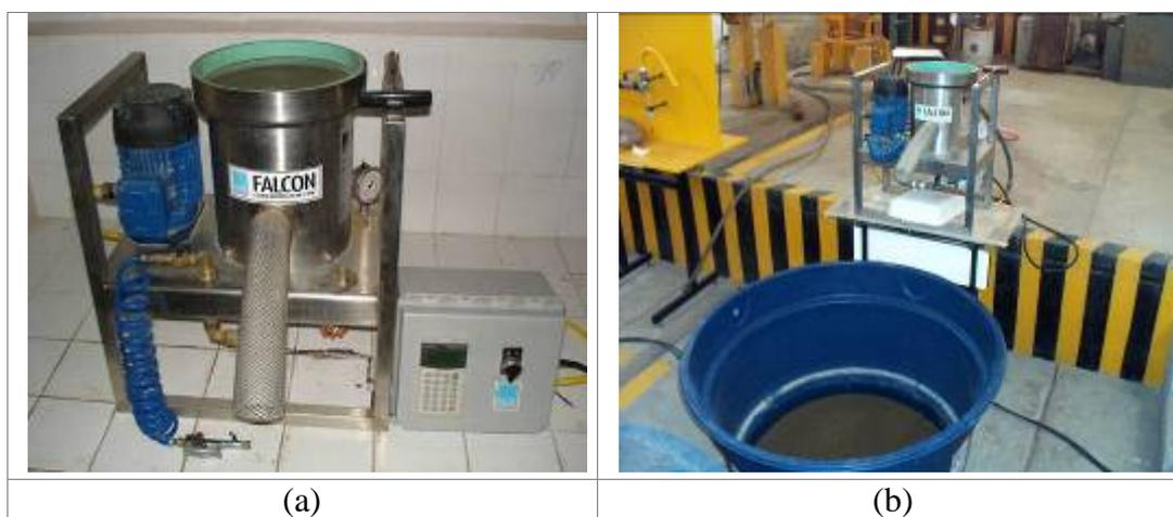
Figura 19 - Concentrador centrífugo Falcon SB-40 (Fernandes, 2008).
