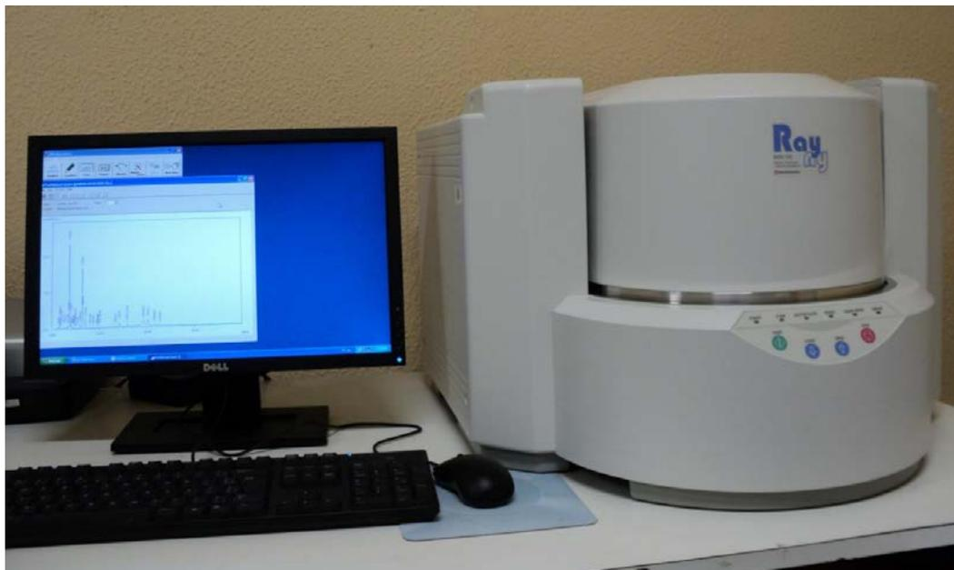
Figura 24 - Espectrômetro de fluorescência de raios-x utilizado na análise química.
