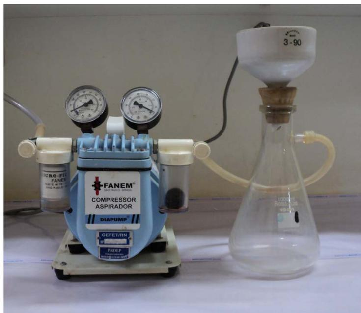
Figura 29 - Aparelhagem utilizada na separação sólido-líquido da polpa.
