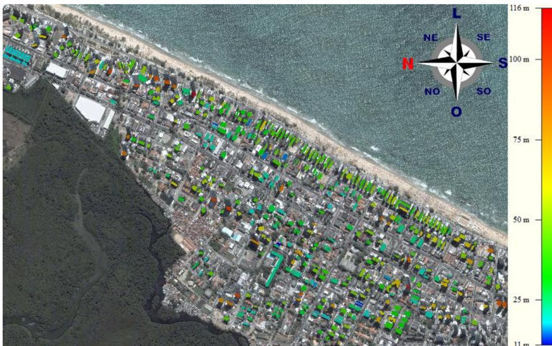
Figura 41 - Formas (2D) dos edifícios de Boa Viagem digitalizados com escala de altura.
