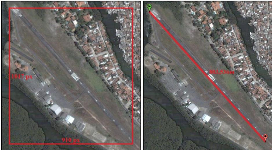
Figura 37 - Dimensões horizontal e vertical em pixels e total em metros da pista do Aeroclube.
