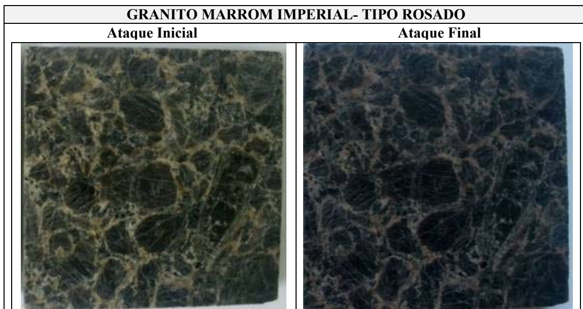
Figura 3.53- Placas do “granito” Marrom Imperial- Rosado, aspecto inicial e final da aplicação do vinagre.
