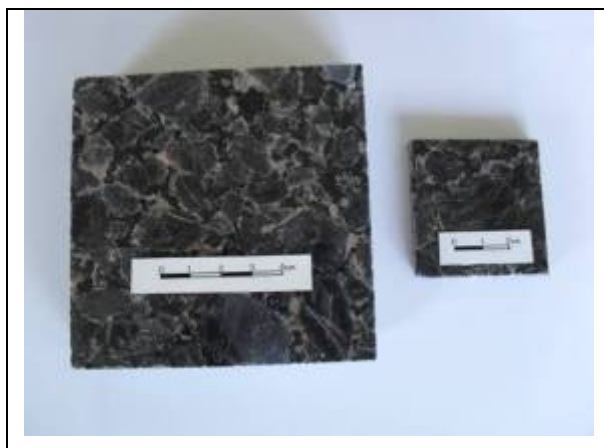
Figura 2.2- Placas polidas com dimensões de 10 x 10 x 2 cm e 5 x 5 x 1 cm.
