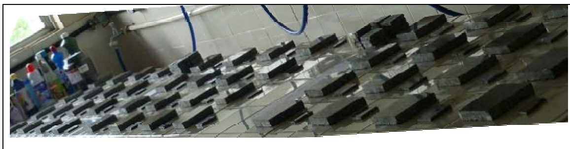
Figura 2.3- Placas do “granito” Marrom Imperial e os insumos utilizados no ensaio de alterabilidade.
